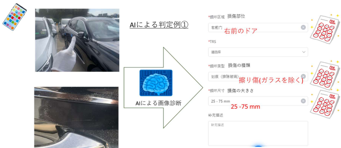
図7. 画像診断による損傷の検出について①
