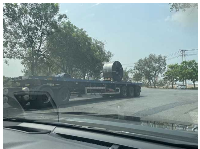
スチールコイルの輸送 チェーンで固縛されていたが、雨除けカバーは施 されていない。
