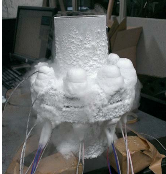
図 3 冷却実験中の管フランジ締結体
