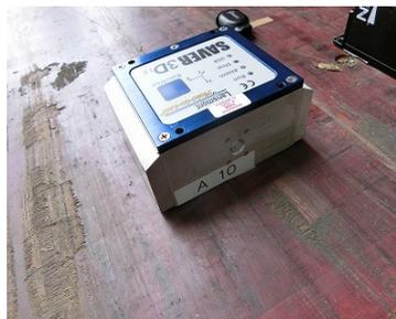
図 2-4 コンテナ床面への接着
