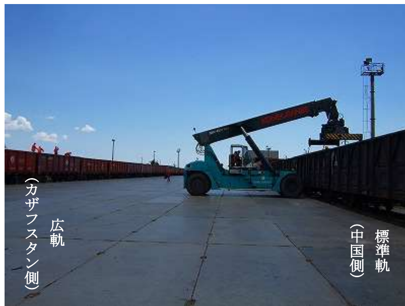
図表 50 貨物積替えエリア 1 ～低床ホームでのリーチスタッカーによる積替え～
