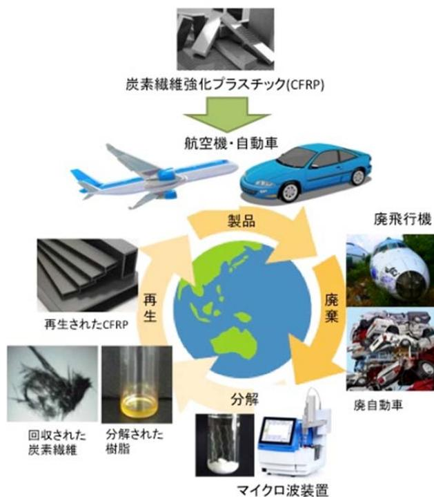
図1. マイクロ波を用いるCFRPの分解とリサイクルの概念図
