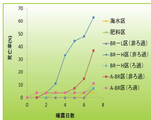
図 3 試験海水に暴露したジャワメダカの死亡率
