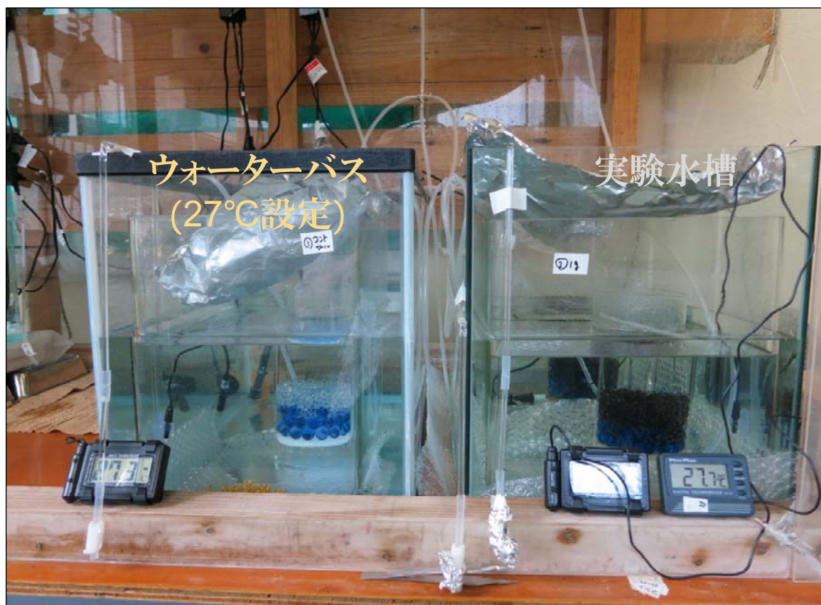
図3 石油分解装置を組み込んだガラス水槽
