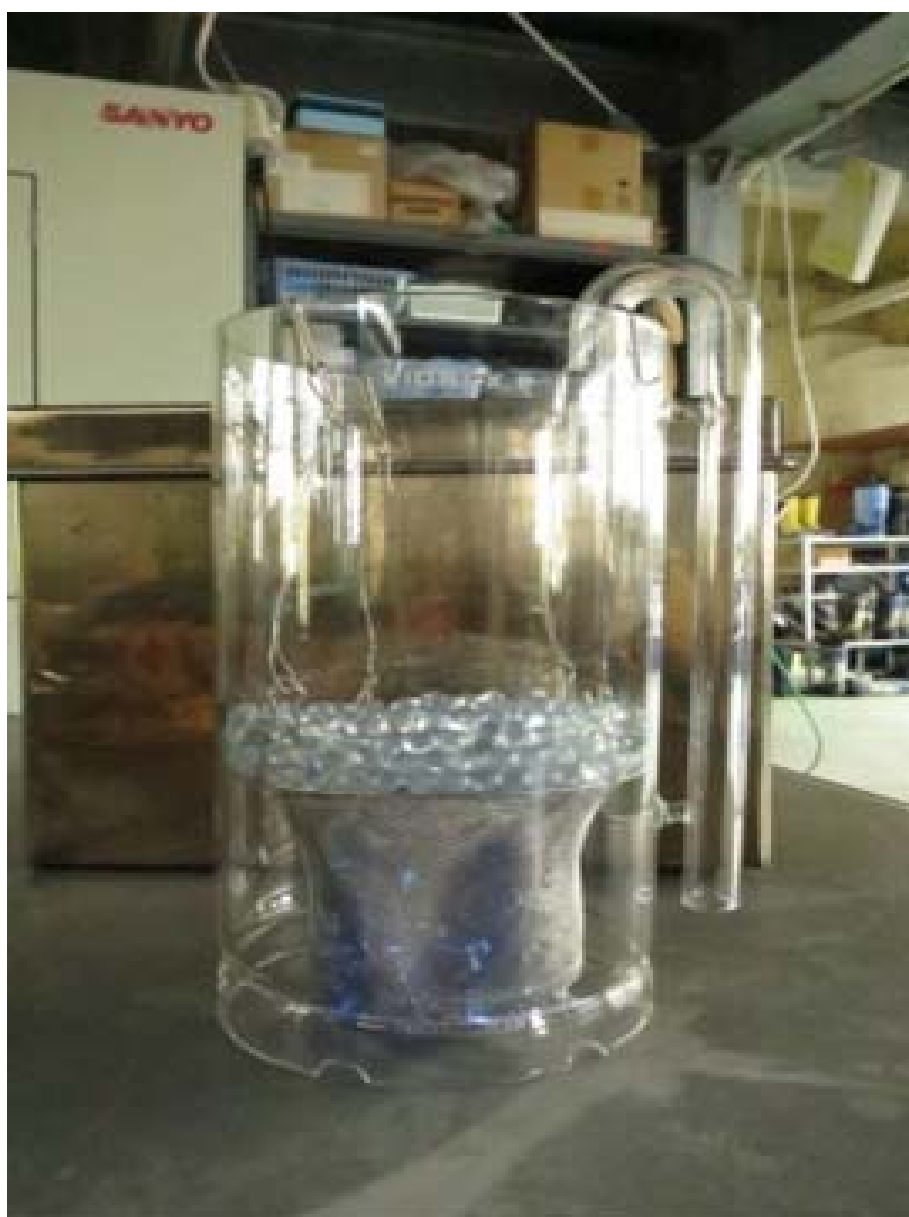
図 2 石油分解装置（ガラス製）
