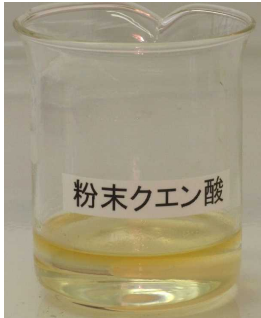
Fig. 5-5 粉末無水クエン酸を用いた相分離試験により得られた生成物の写真 (模擬副生グリセリン類)
