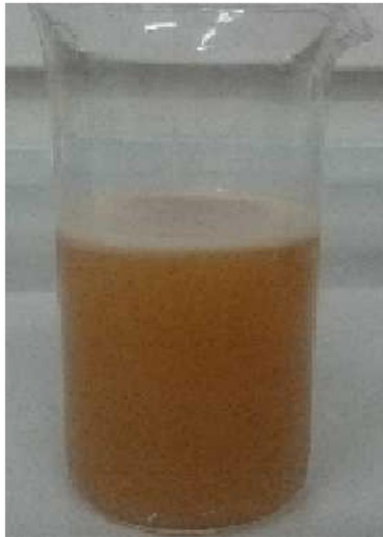
Fig. 5-7 副生グリセリン類：蒸留水=1：10の写真
