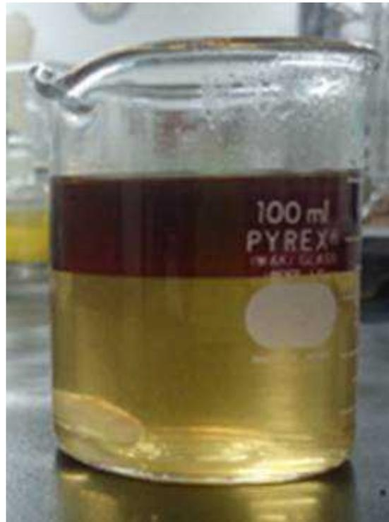
Fig. 5-16 廃食用油由来の副生グリセリン類を酢酸処理した溶液
