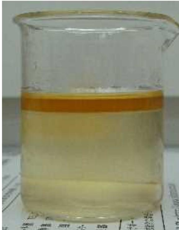
Fig. 5-14 未使用油由来の副生グリセリン類を酢酸処理した溶液
