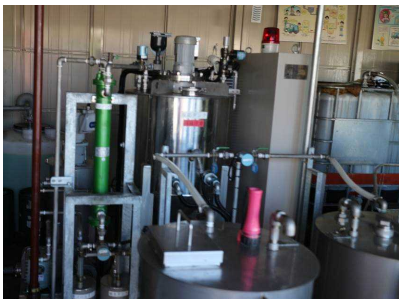
Fig. 3-16 D・Oil 100A の装置外観 (於 横手市バイオディーゼル燃料化施設, 2014 年 9 月 16 日撮影)
