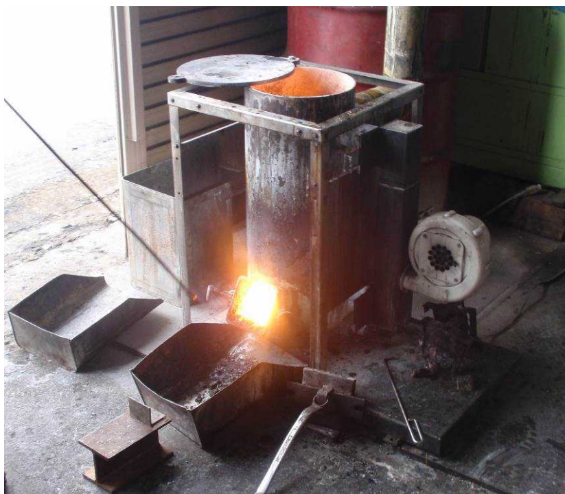
Fig. 4-8 市販廃油ストーブを改良した副生グリセリン燃焼ストーブ (於 鹿角衛生協業組合, 2014 年 12 月 9 日撮影)
