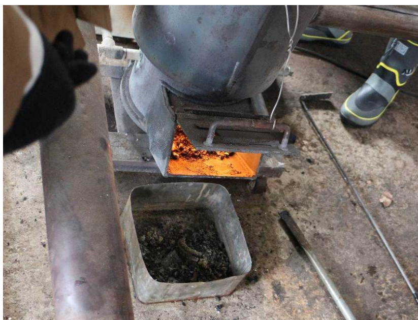
Fig. 4-11 副生グリセリン燃焼ストーブから発生した固形物 (於 鹿角衛生協業組合, 2014 年 12 月 9 日撮影)
