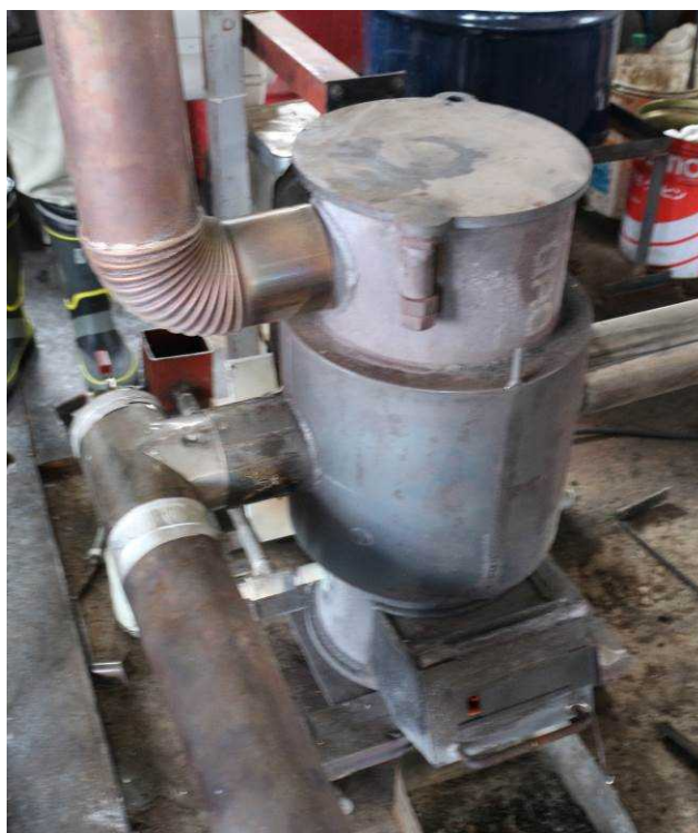
Fig. 4-10 副生グリセリン燃焼ストーブ (於 鹿角衛生協業組合, 2014 年 12 月 9 日撮影)
