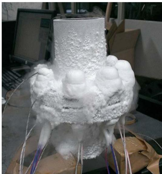
図 12 管フランジモデルへの液体窒素の注入試験
