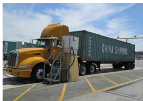
写真 3.1-4 コンテナ重量測定ピット
