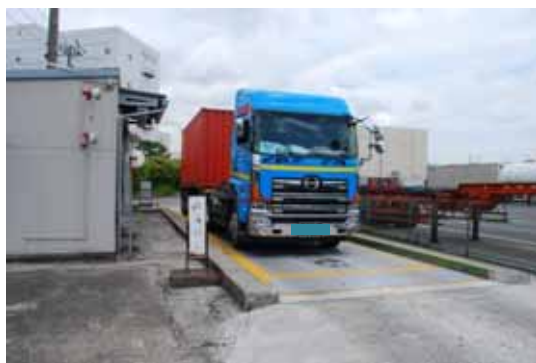
写真 3.3-5 計量手順 1 (コンテナ搬入)
