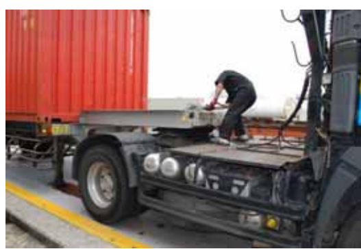
写真 3.3-8 計量手順 4 (ヘッドの取り付け)
