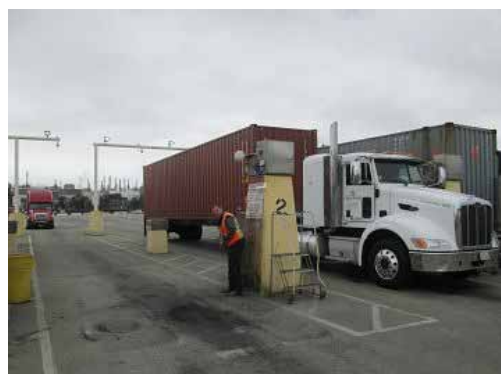
写真 3.1-16 コンテナ重量測定後の 結果 & 行先指示票出力
