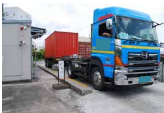
写真 3.3-6 計量手順 2 (ヘッドの取り外し)
