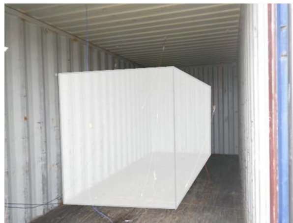
【図 13】本年度のイメージ図(部分的に段ボール箱を積み上げ、その周り全面を発泡スチロールボードで覆った。)
