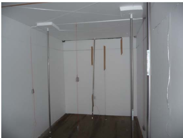
【図 12】昨年度の実験環境(コンテナ内壁、天井の全面を発泡スチロールボードで覆った。)
