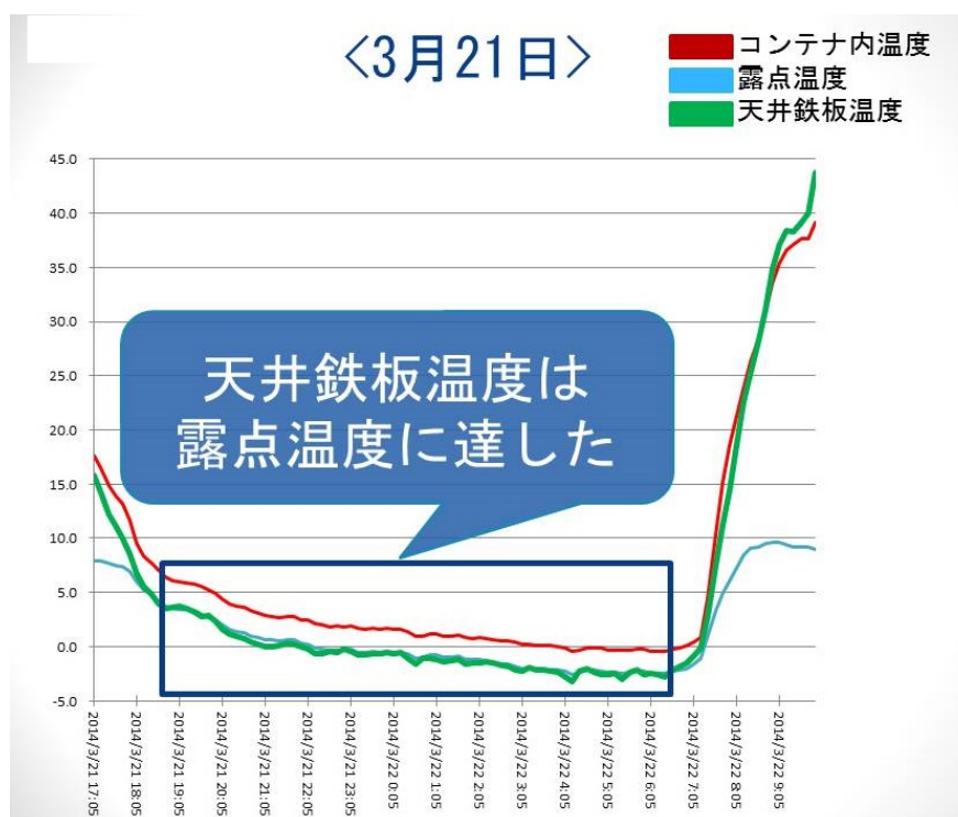
【図 13】コンテナ内、天井鉄板と露点温度の関係
