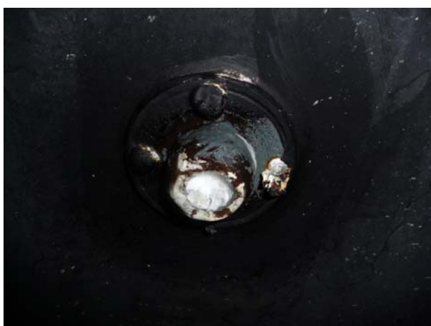
【図 22】 ドア側ドレンホール(氷で閉鎖)
