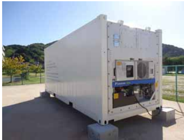
図5:冷凍コンテナ支持台
