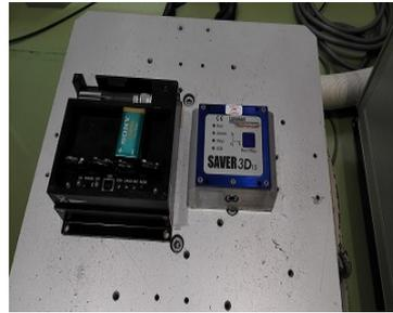
図 2-4 振動試験機で加振試験
