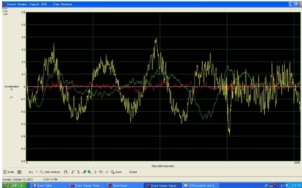
図 6-5 Z 軸 :  $\pm 0.35G$ 、Y 軸 :  $\pm 0.15G$ 、X 軸 :  $\pm 0.02G$
