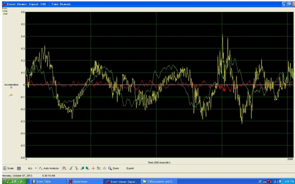
図 6-3 Z 軸 :  $\pm 0.25G$ 、Y 軸 :  $\pm 0.2G$ 、X 軸 :  $\pm 0.02G$
