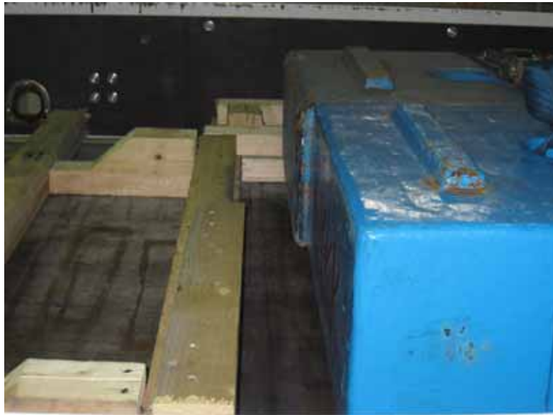
図 2-14 時速 40km からの急停止により前方に移動した貨物
