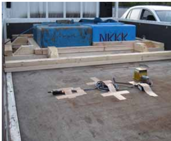
図 2-2 荷台前方が積載貨物（1t 基準分銅を 2 つ） 計測機（黄色）は荷台の中央部に両面テープにて設置 計測器用電源、プレートース及びケーブルはガムテープで保定
