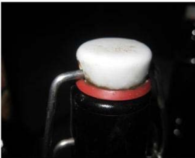
写真 24：飲料ビンの栓回りに発生した黴
