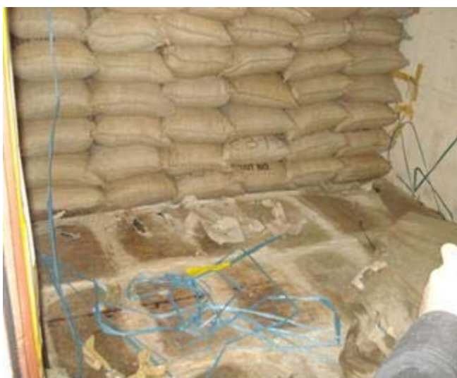
写真 11：冠水による貨物最下段の濡れ
