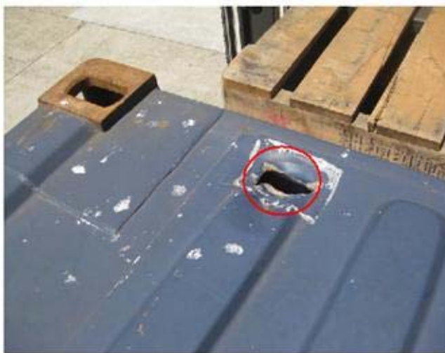
写真 7：ツイストロックピンで空いた穴
