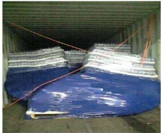
写真 14：積付・保定不良による荷崩れ
