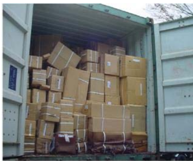
写真 12：冠水による貨物下段の濡れによる荷崩
