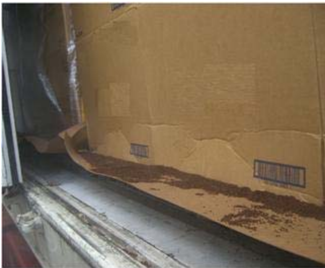
写真 16：前荷のコーヒー粉による汚損
