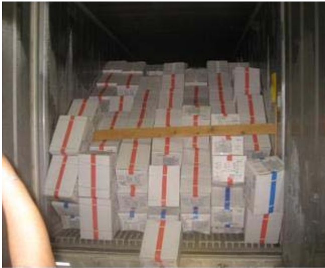
写真 13：コンテナ後部への荷崩れ
