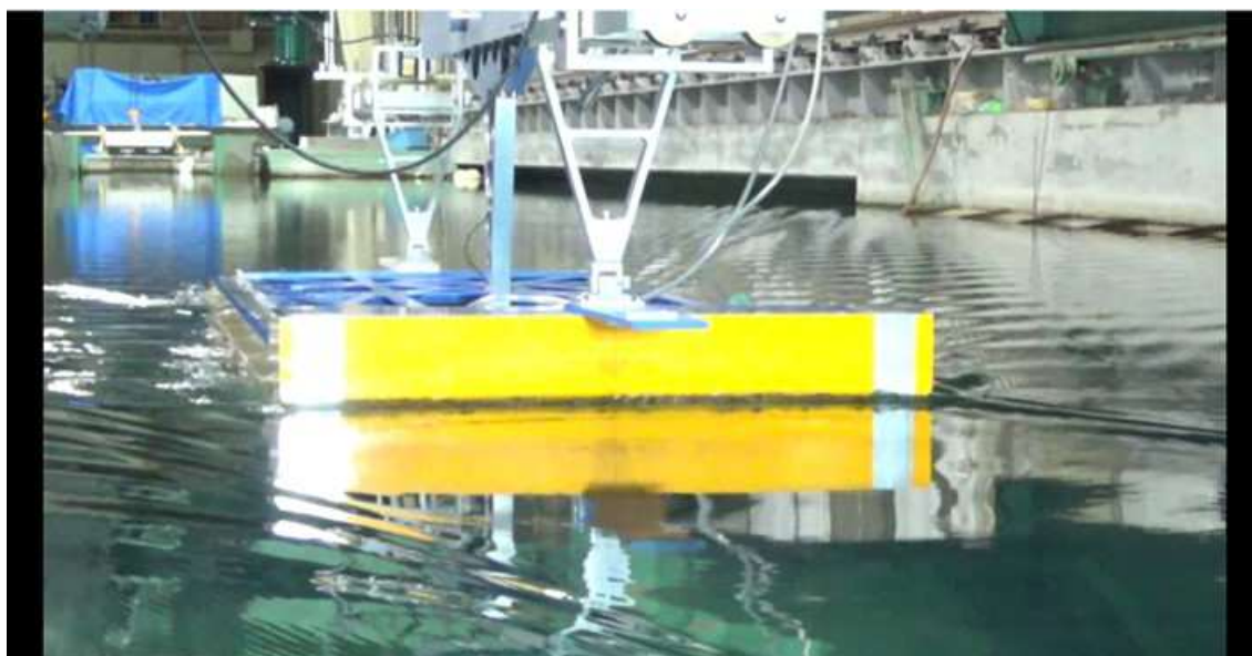
CASE-6、 d=2\text{m} 、 \text{trim}=0 V_m=0.756\text{m/s} 、 F_n=0.182 、 V_s=9.0\text{kn}
