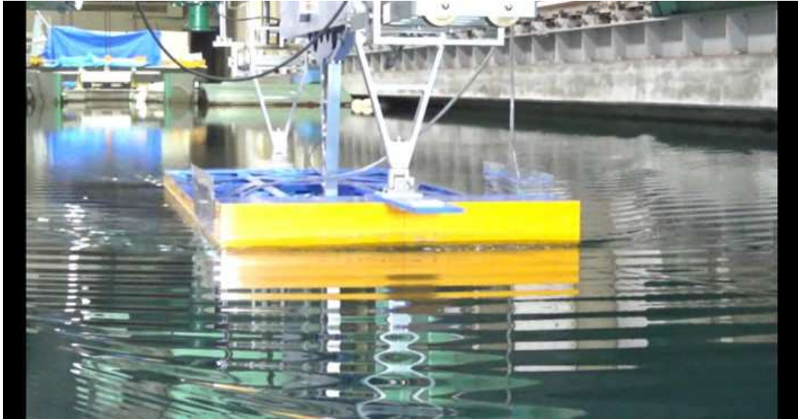
CASE-1、 d=3\text{m} 、 \text{trim}=0 V_m=0.504\text{m/s} 、 F_n=0.122 、 V_s=6.0\text{kn}
