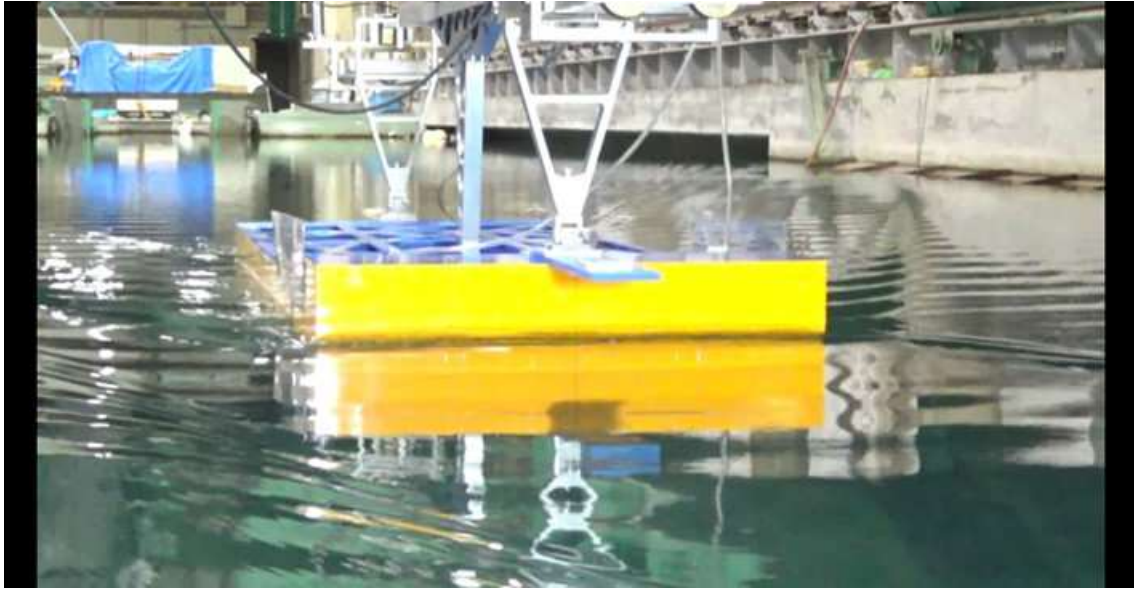
CASE-3、 d=2\text{m} 、 \text{trim}=0 V_m=0.656\text{m/s} 、 F_n=0.158 、 V_s=8.0\text{kn}
