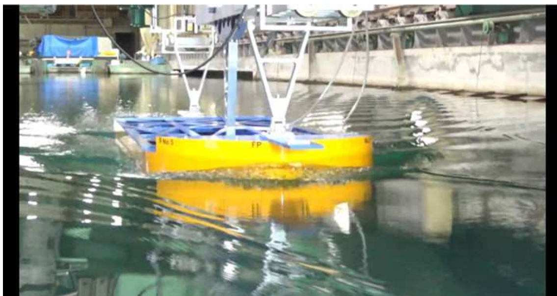
CASE-5、 d=2\text{m} 、 \text{trim}=0 V_m=0.967\text{m/s} 、 Fn=0.233 、 V_s=12.0\text{kn}
