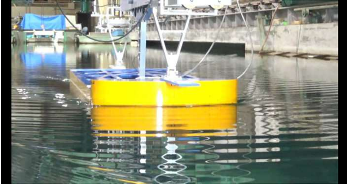
CASE-4、 d=2\text{m} 、 \text{trim}=0 V_m=0.492\text{m/s} 、 F_n=0.119 、 V_s=6.0\text{kn}
