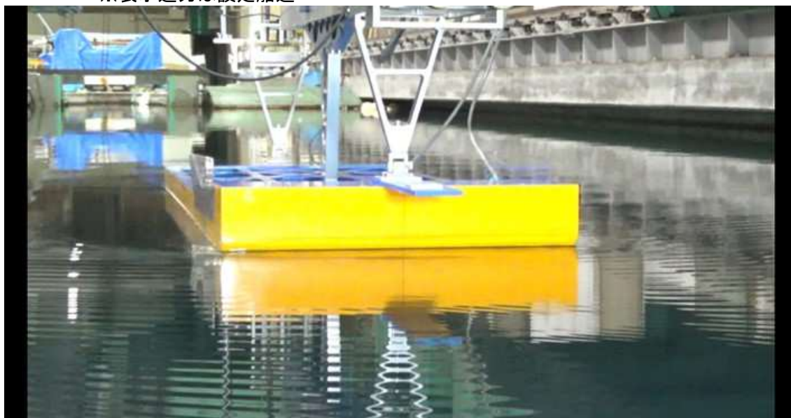
CASE-3、 d=2\text{m} 、 \text{trim}=1 V_m=0.328\text{m/s} 、 F_n=0.079 、 V_s=4.0\text{kn}
