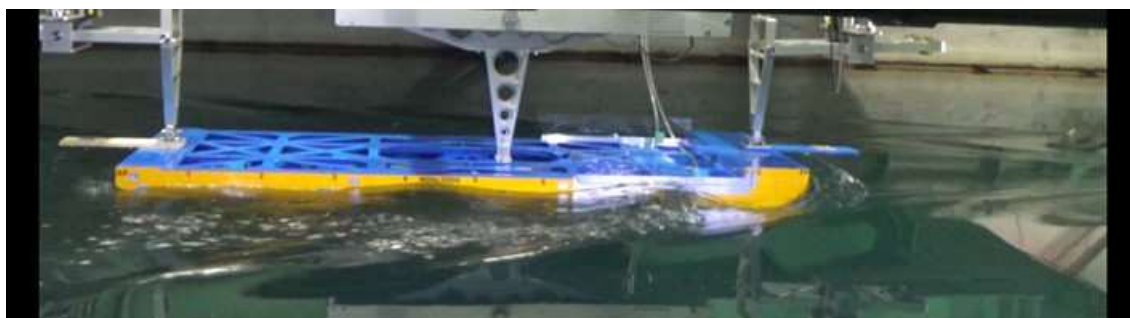
CASE-3、 d=3\text{m} 、 \text{trim}=0 V_m=1.066\text{m/s} 、 F_n=0.257 、 V_s=13.0\text{kn}
