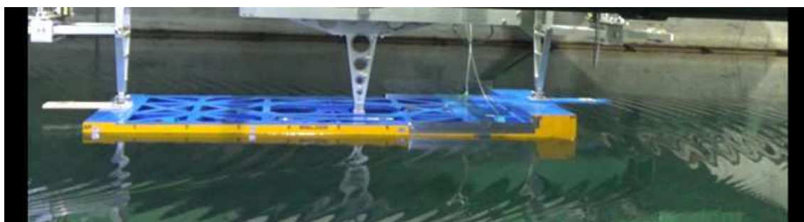
CASE-3、 d=3\text{m} 、 \text{trim}=1 V_m=0.410\text{m/s} 、 Fn=0.099 、 V_s=5.0\text{kn}
