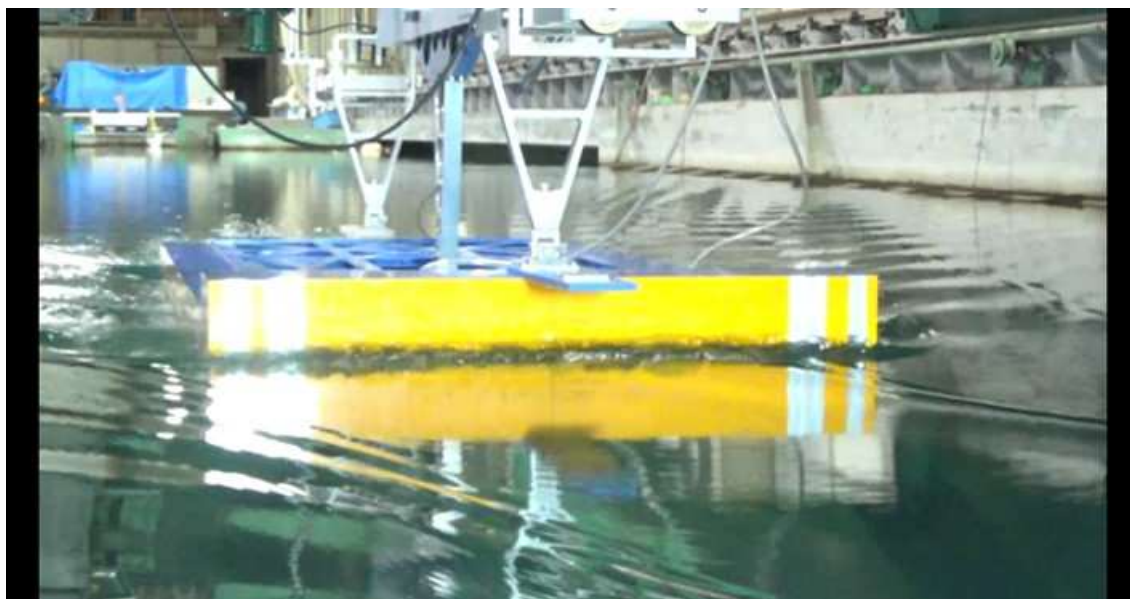
CASE-7、 d=2\text{m} 、 \text{trim}=0 V_m=0.924\text{m/s} 、 F_n=0.223 、 V_s=11.0\text{kn}
