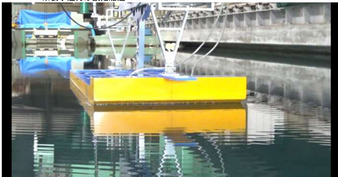
CASE-1、 d=2\text{m} 、 \text{trim}=1 V_m=0.336\text{m/s} 、 F_n=0.081 、 V_s=4.0\text{kn}
