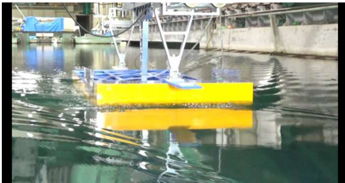
CASE-3、 d=2\text{m} 、 \text{trim}=0 V_m=0.820\text{m/s} 、 F_n=0.198 、 V_s=10.0\text{kn}
