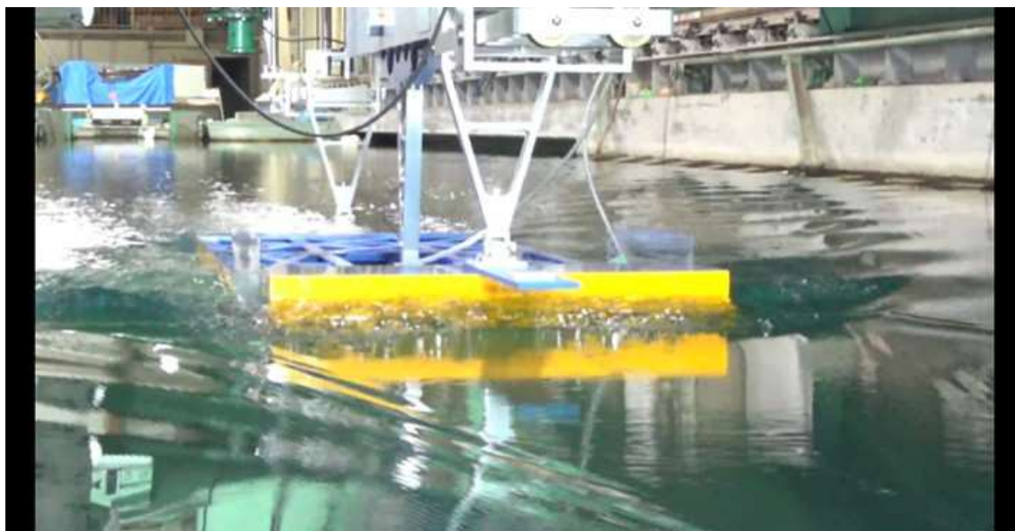
CASE-3、 d=3\text{m} 、 \text{trim}=1 V_m=1.066\text{m/s} 、 F_n=0.257 、 V_s=13.0\text{kn}
