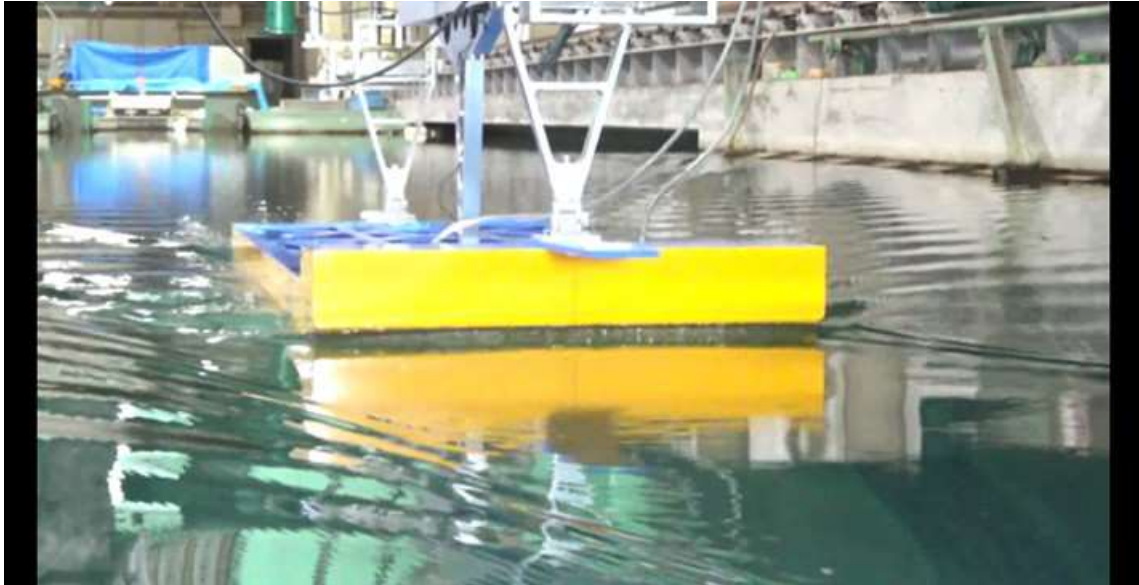
CASE-1、 d=2\text{m} 、 \text{trim}=1 V_m=0.840\text{m/s} 、 Fn=0.203 、 V_s=10.0\text{kn}
