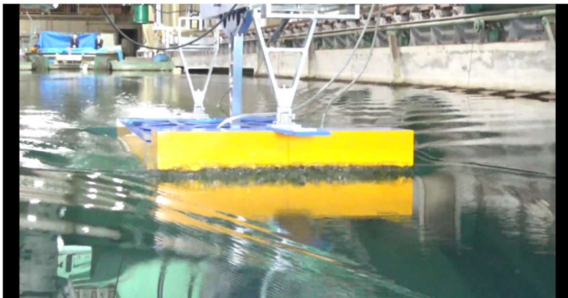
CASE-1、 d=2\text{m} 、 \text{trim}=1 V_m=1.092\text{m/s} 、 Fn=0.263 、 V_s=13.0\text{kn}
