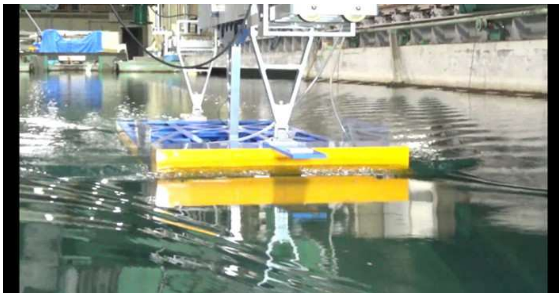
CASE-3、 d=3\text{m} 、 \text{trim}=0 V_m=0.820\text{m/s} 、 F_n=0.198 、 V_s=10.0\text{kn}
