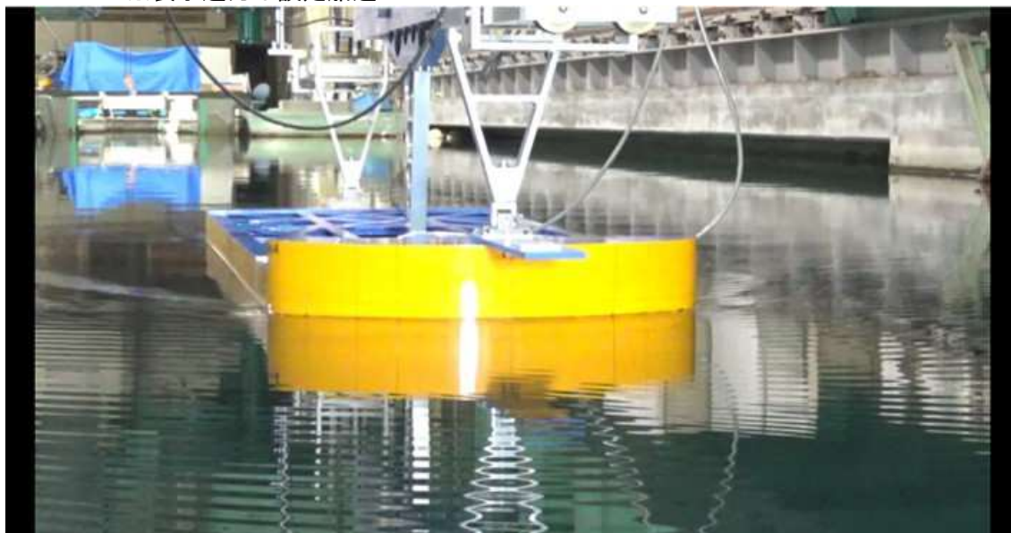
CASE-4、 d=2\text{m} 、 \text{trim}=0 V_m=0.328\text{m/s} 、 F_n=0.079 、 V_s=4.0\text{kn}
