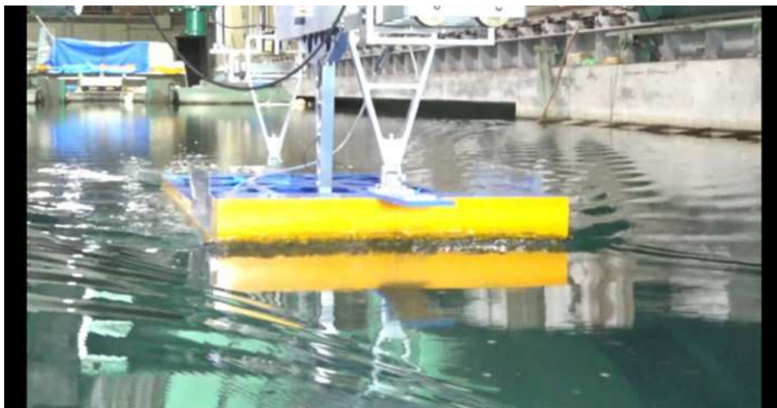
CASE-1、 d=3\text{m} 、 \text{trim}=1 V_m=0.840\text{m/s} 、 F_n=0.203 、 V_s=10.0\text{kn}
