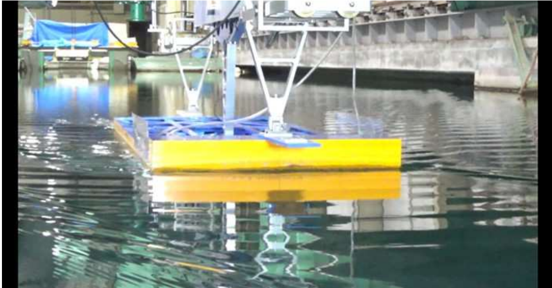
CASE-1、 d=3\text{m} 、 \text{trim}=0 V_m=0.588\text{m/s} 、 F_n=0.142 、 V_s=7.0\text{kn}
