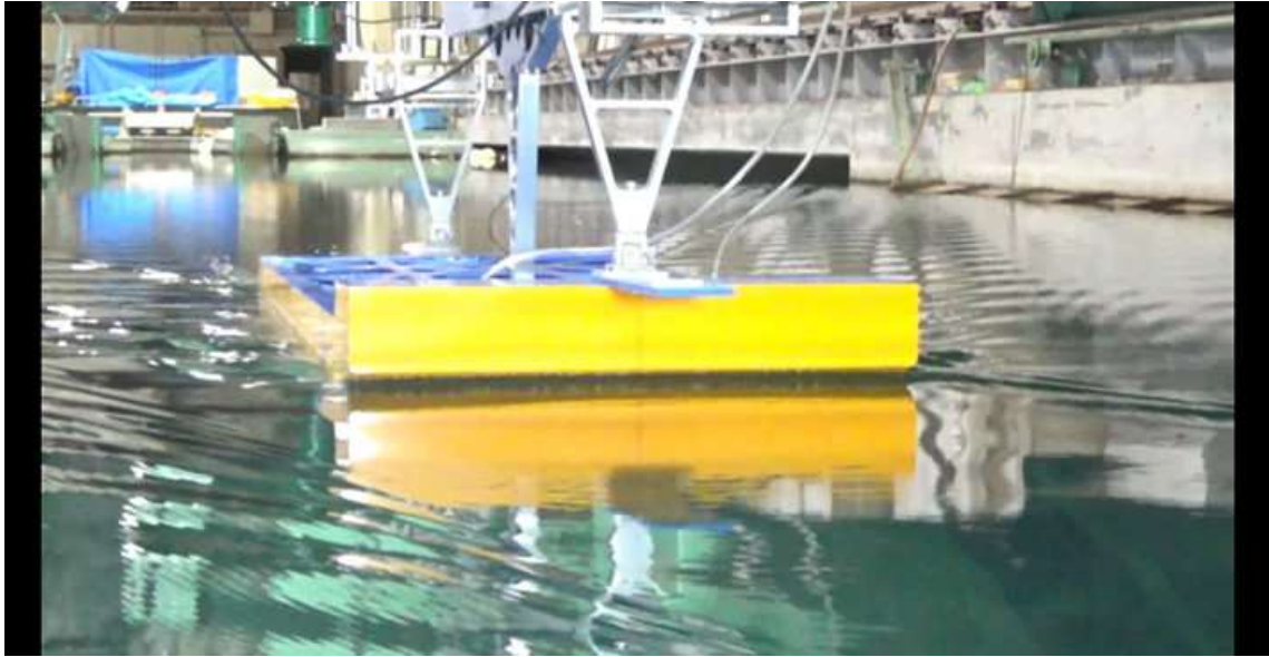
CASE-1、 d=2\text{m} 、 \text{trim}=1 V_{im}=0.756\text{m/s} 、 F_n=0.182 、 V_s=9.0\text{kn}
