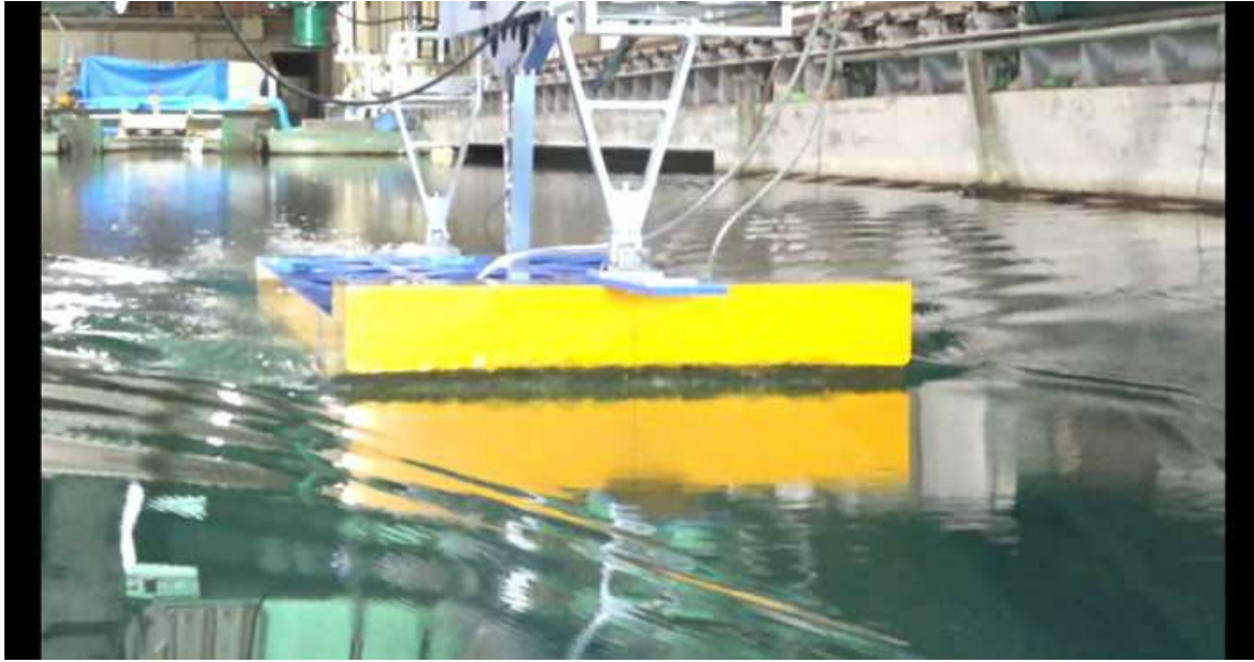
CASE-1、 d=2\text{m} 、 \text{trim}=1 V_m=1.008\text{m/s} 、 Fn=0.243 、 V_s=12.0\text{kn}
