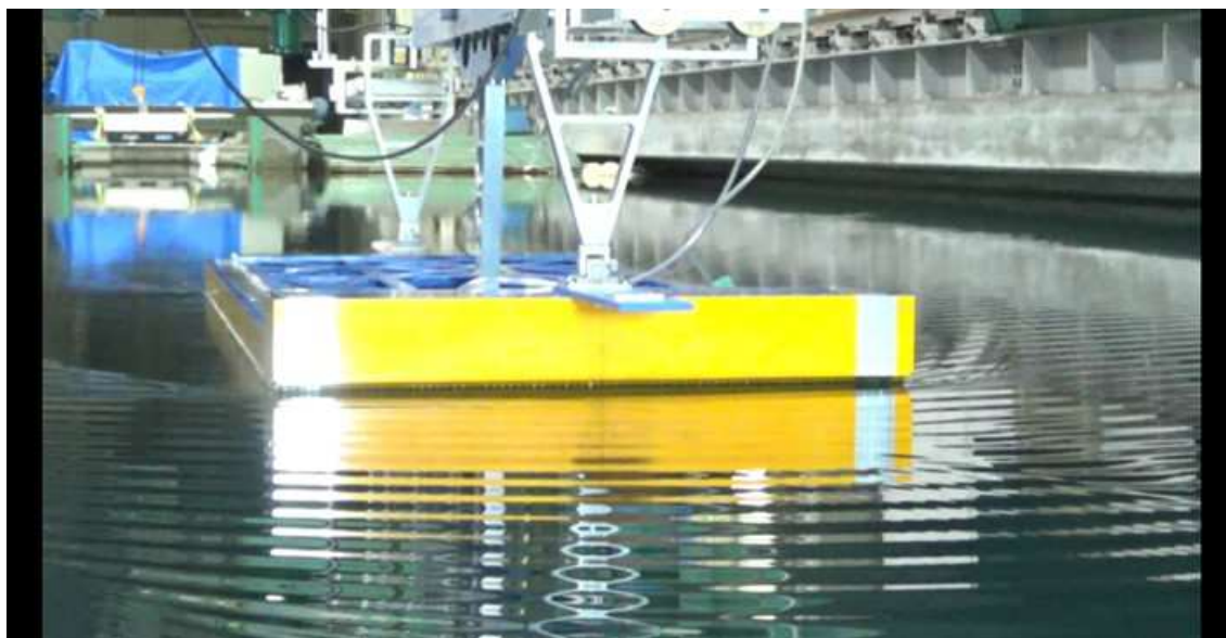
CASE-6、 d=2\text{m} 、 \text{trim}=0 V_m=0.420\text{m/s} 、 F_n=0.101 、 V_s=5.0\text{kn}
