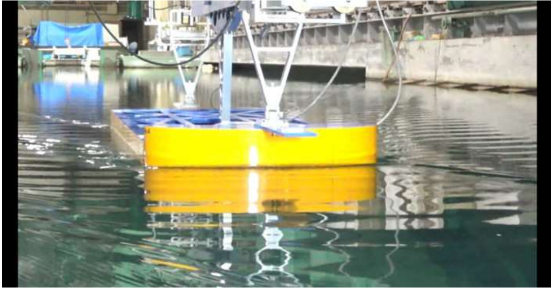
CASE-4、 d=2\text{m} 、 \text{trim}=0 V_m=0.574\text{m/s} 、 F_n=0.139 、 V_s=7.0\text{kn}
