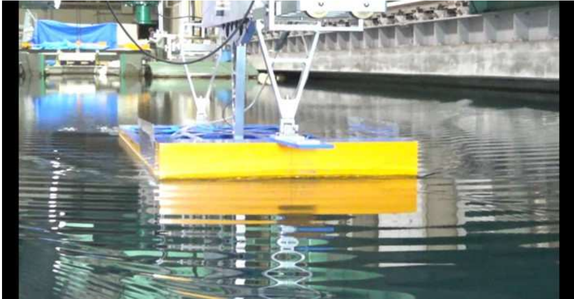
CASE-1、 d=3\text{m} 、 \text{trim}=1 V_m=0.504\text{m/s} 、 F_n=0.122 、 V_s=6.0\text{kn}
