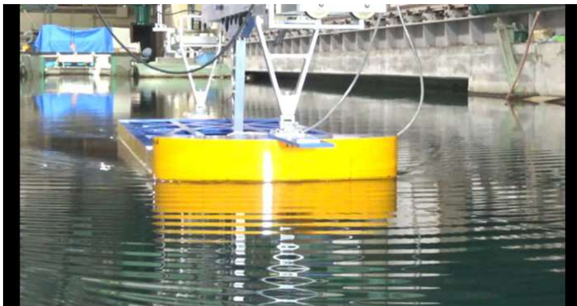
CASE-4、 d=2\text{m} 、 \text{trim}=0 V_m=0.410\text{m/s} 、 Fn=0.099 、 V_s=5.0\text{kn}
