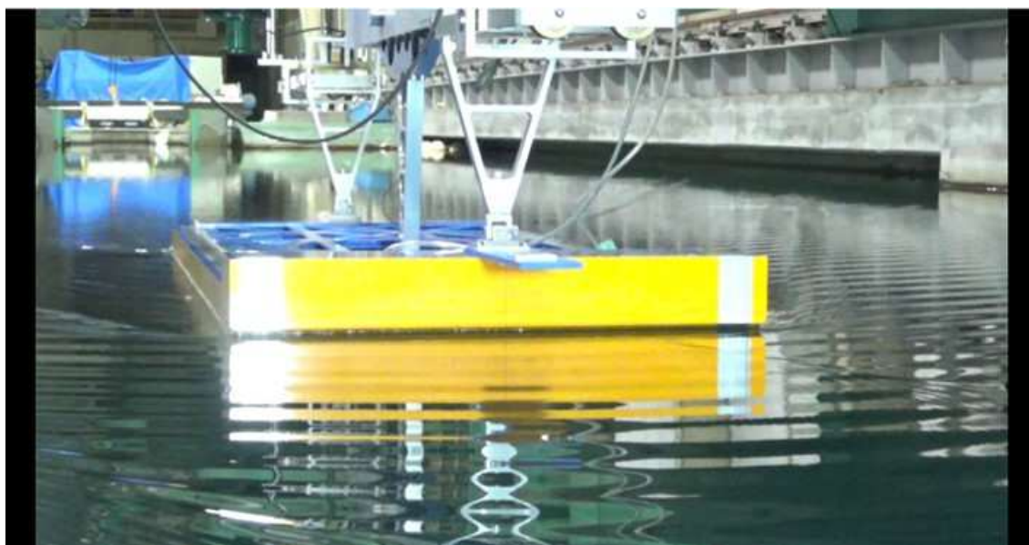
CASE-6、 d=2\text{m} 、 \text{trim}=0 V_m=0.504\text{m/s} 、 F_n=0.122 、 V_s=6.0\text{kn}
