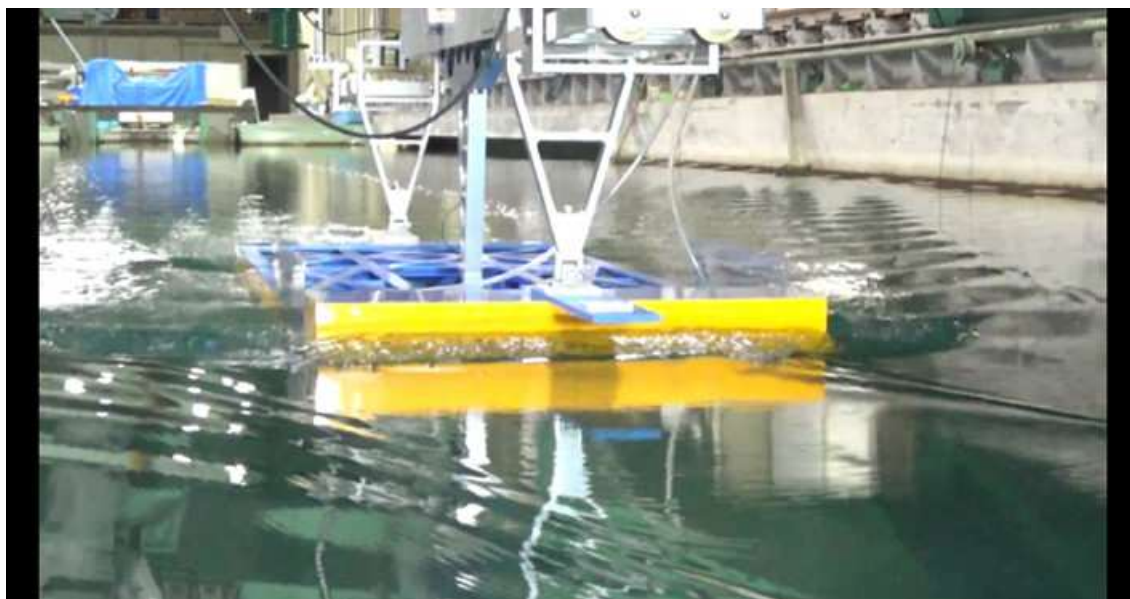
CASE-3、 d=3\text{m} 、 \text{trim}=0 V_m=0.902\text{m/s} 、 F_n=0.218 、 V_s=11.0\text{kn}
