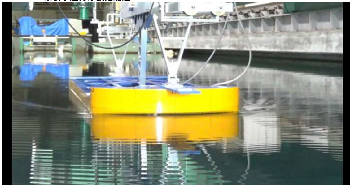
CASE-2、 d=2\text{m} 、 \text{trim}=0 V_m=0.336\text{m/s} 、 F_n=0.081 、 V_s=4.0\text{kn}
