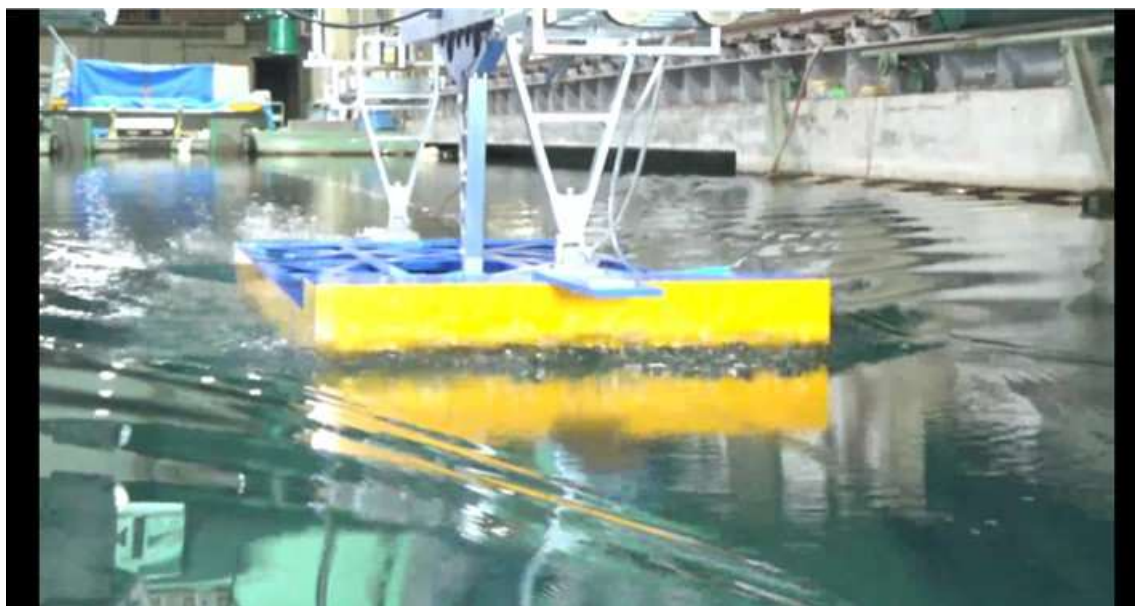
CASE-1、 d=2\text{m} 、 \text{trim}=0 V_m=1.092\text{m/s} 、 Fn=0.263 、 V_s=13.0\text{kn}
