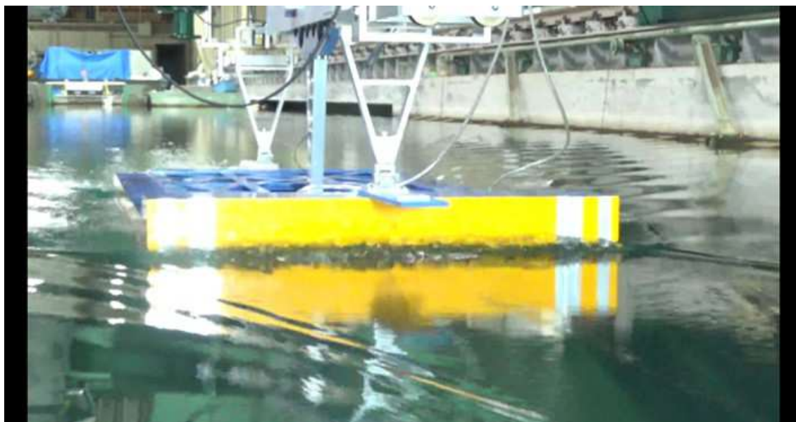
CASE-7、 d=2\text{m} 、 \text{trim}=0 V_m=1.008\text{m/s} 、 F_n=0.243 、 V_s=12.0\text{kn}
