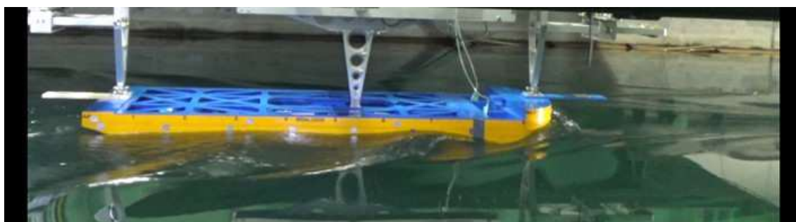
CASE-2、 d=2\text{m} 、 \text{trim}=0 V_m=1.092\text{m/s} 、 F_n=0.263 、 V_s=13.0\text{kn}
