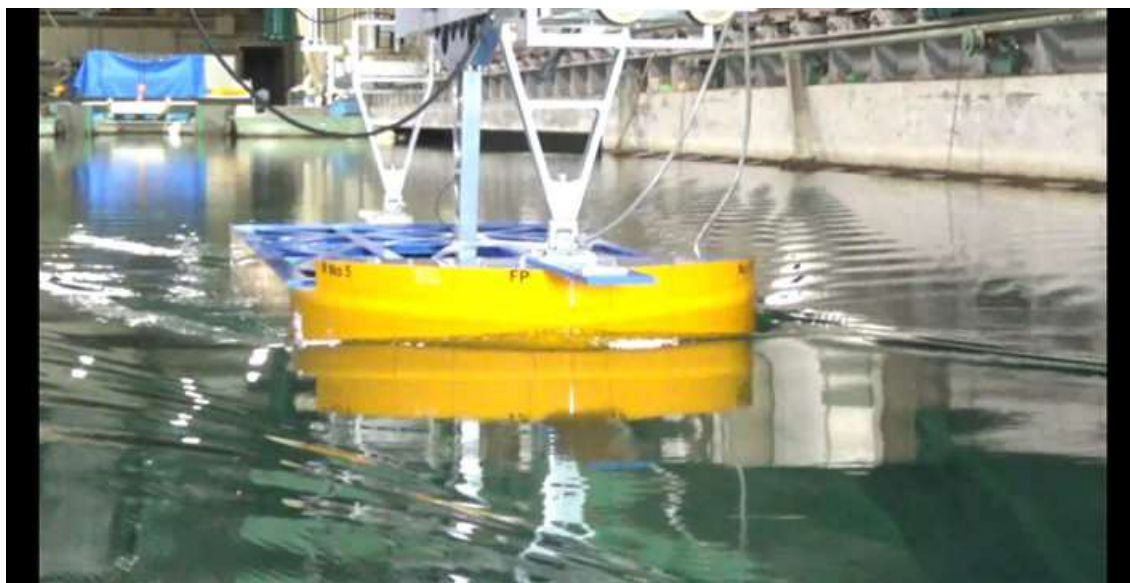
CASE-5、 d=2\text{m} 、 \text{trim}=0 V_m=0.725\text{m/s} 、 F_n=0.175 、 V_s=9.0\text{kn}
