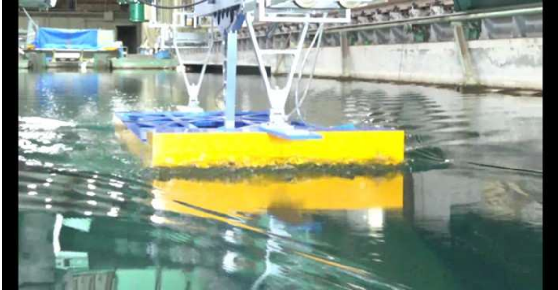
CASE-1、 d=2\text{m} 、 \text{trim}=0 V_m=1.008\text{m/s} 、 Fn=0.243 、 V_s=12.0\text{kn}
