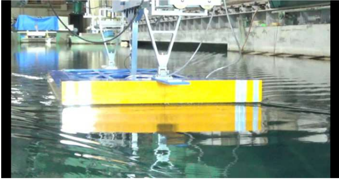
CASE-7、 d=2m 、 \text{trim}=0 V_m=0.672m/s 、 Fn=0.162 、 V_s=8.0kn
