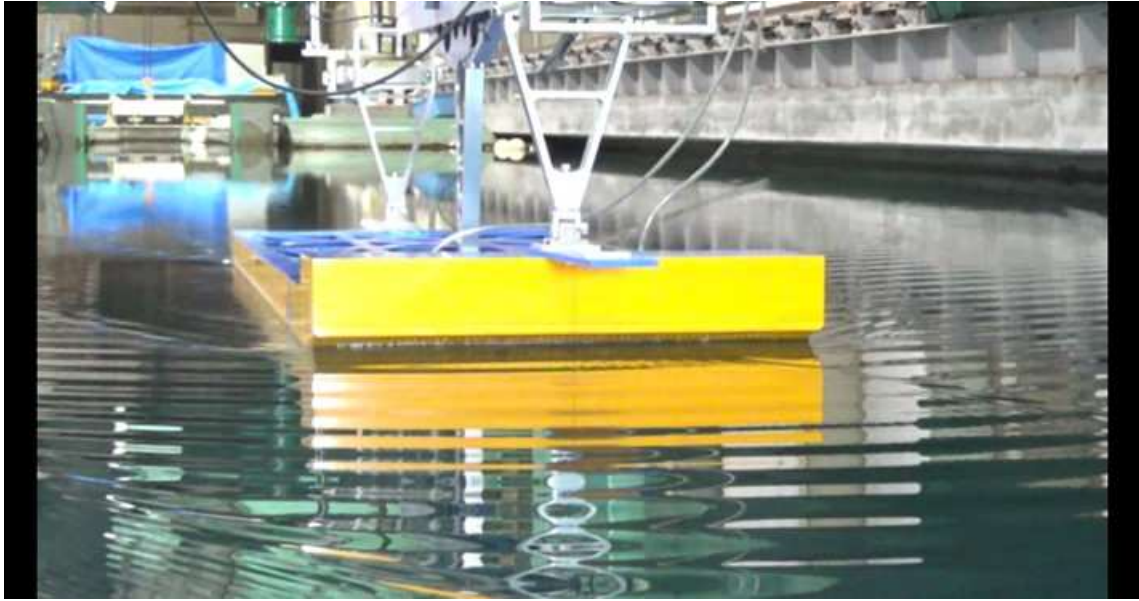
CASE-1、 d=2\text{m} 、 \text{trim}=1 V_m=0.504\text{m/s} 、 Fn=0.122 、 V_s=6.0\text{kn}
