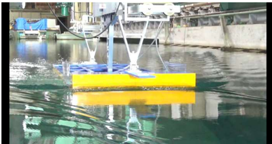
CASE-3、 d=3\text{m} 、 \text{trim}=1 V_m=0.820\text{m/s} 、 F_n=0.198 、 V_s=10.0\text{kn}
