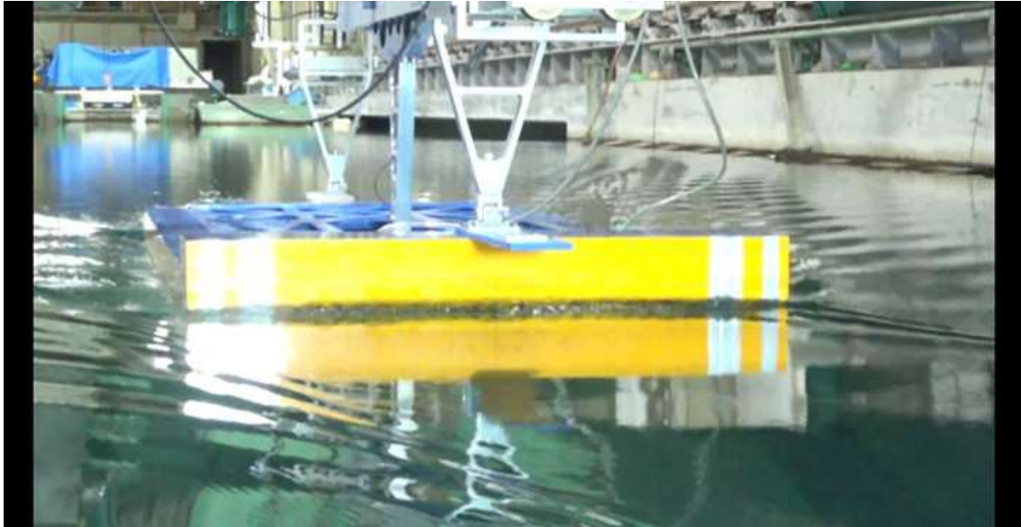
CASE-7、 d=2\text{m} 、 \text{trim}=0 V_m=0.840\text{m/s} 、 F_n=0.203 、 V_s=10.0\text{kn}
