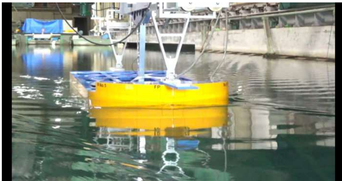
CASE-5、 d=2\text{m} 、 \text{trim}=0 V_m=0.645\text{m/s} 、 Fn=0.155 、 V_s=8.0\text{kn}
