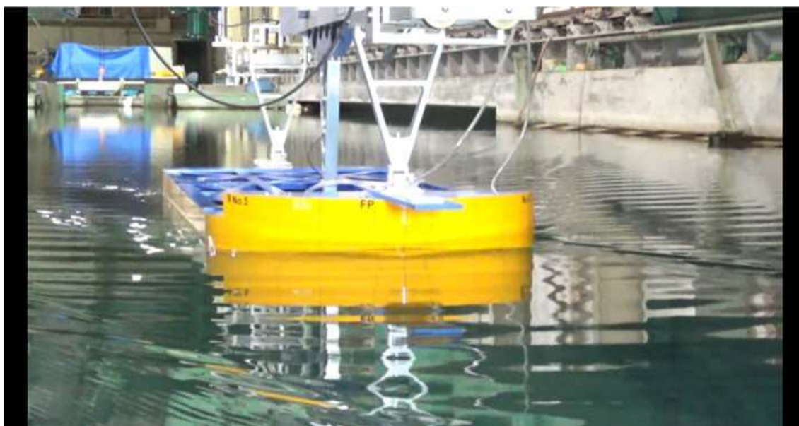
CASE-5、 d=2\text{m} 、 \text{trim}=0 V_m=0.564\text{m/s} 、 Fn=0.136 、 V_s=7.0\text{kn}
