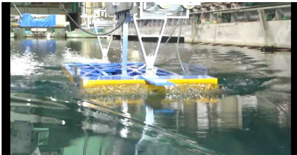
CASE-3、 d=3\text{m} 、 \text{trim}=0 V_m=1.066\text{m/s} 、 F_n=0.257 、 V_s=13.0\text{kn}
