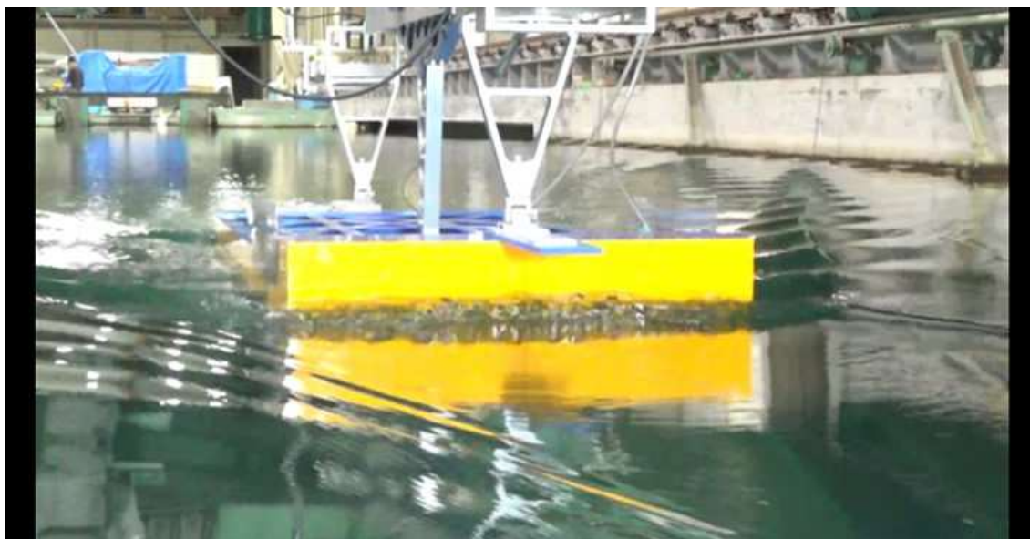
CASE-3、 d=2\text{m} 、 \text{trim}=1 V_m=0.984\text{m/s} 、 F_n=0.237 、 V_s=12.0\text{kn}
