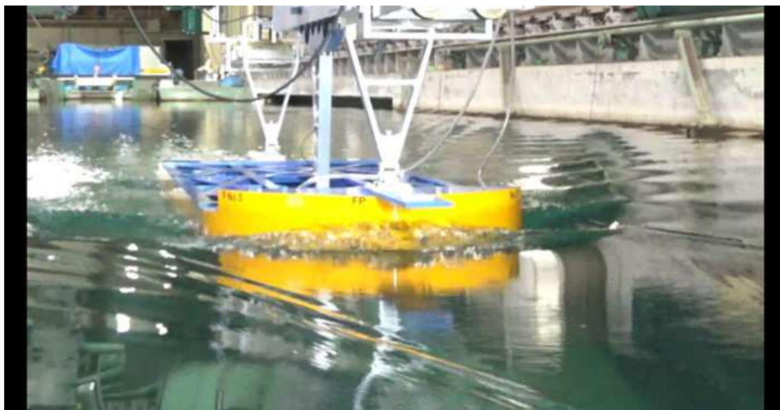
CASE-5、 d=2\text{m} 、 \text{trim}=0 V_m=1.048\text{m/s} 、 F_n=0.253 、 V_s=13.0\text{kn}
