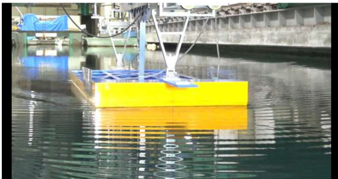
CASE-3、 d=2\text{m} 、 \text{trim}=0 V_m=0.410\text{m/s} 、 Fn=0.099 、 V_s=5.0\text{kn}
