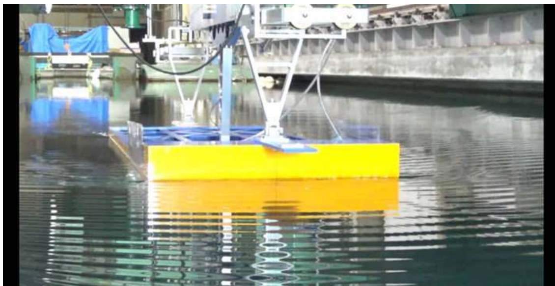
CASE-3、 d=3\text{m} 、 \text{trim}=1 V_m=0.410\text{m/s} 、 Fn=0.099 、 V_s=5.0\text{kn}
