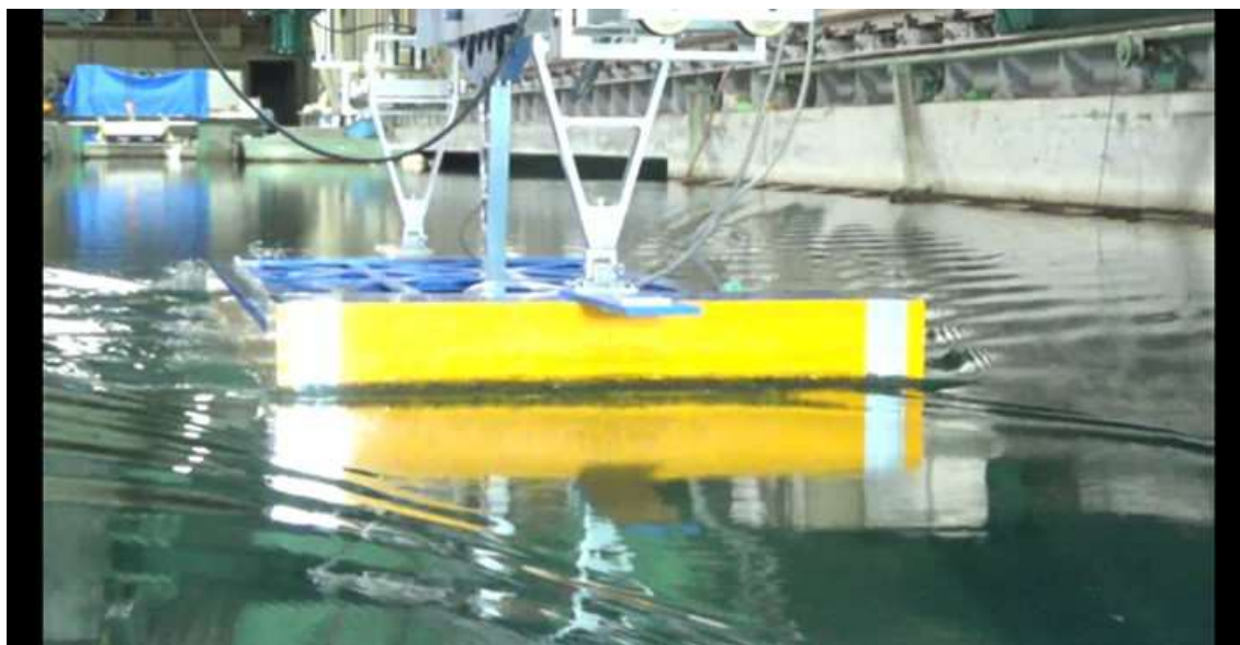
CASE-6、 d=2\text{m} 、 \text{trim}=0 V_m=0.840\text{m/s} 、 F_n=0.203 、 V_s=10.0\text{kn}
