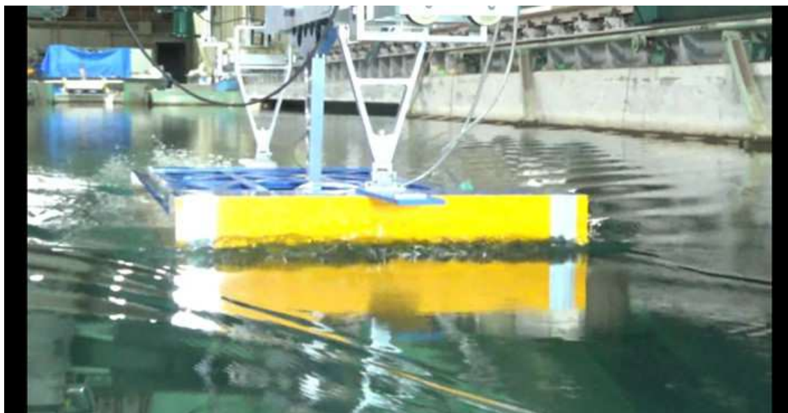
CASE-6、 d=2\text{m} 、 \text{trim}=0 V_m=1.008\text{m/s} 、 F_n=0.243 、 V_s=12.0\text{kn}
