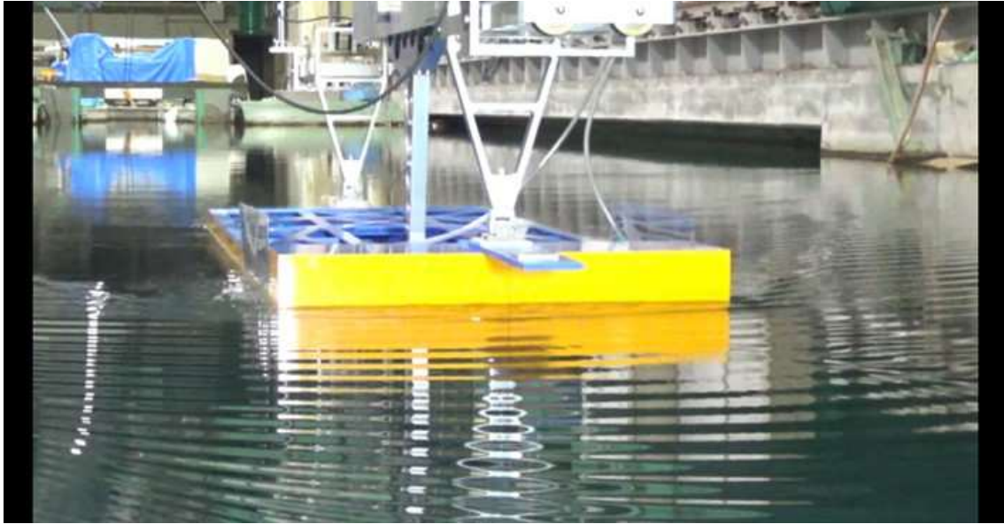
CASE-3、 d=3\text{m} 、 \text{trim}=0 V_m=0.410\text{m/s} 、 F_n=0.099 、 V_s=5.0\text{kn}
