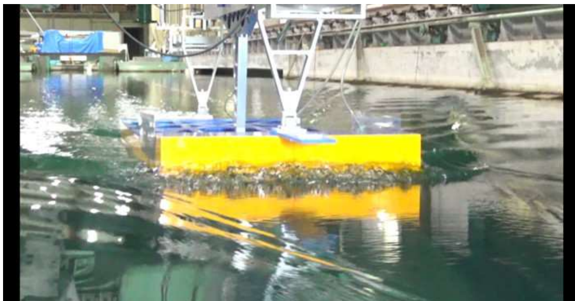
CASE-3、 d=2\text{m} 、 \text{trim}=1 V_m=1.066\text{m/s} 、 F_n=0.257 、 V_s=13.0\text{kn}
