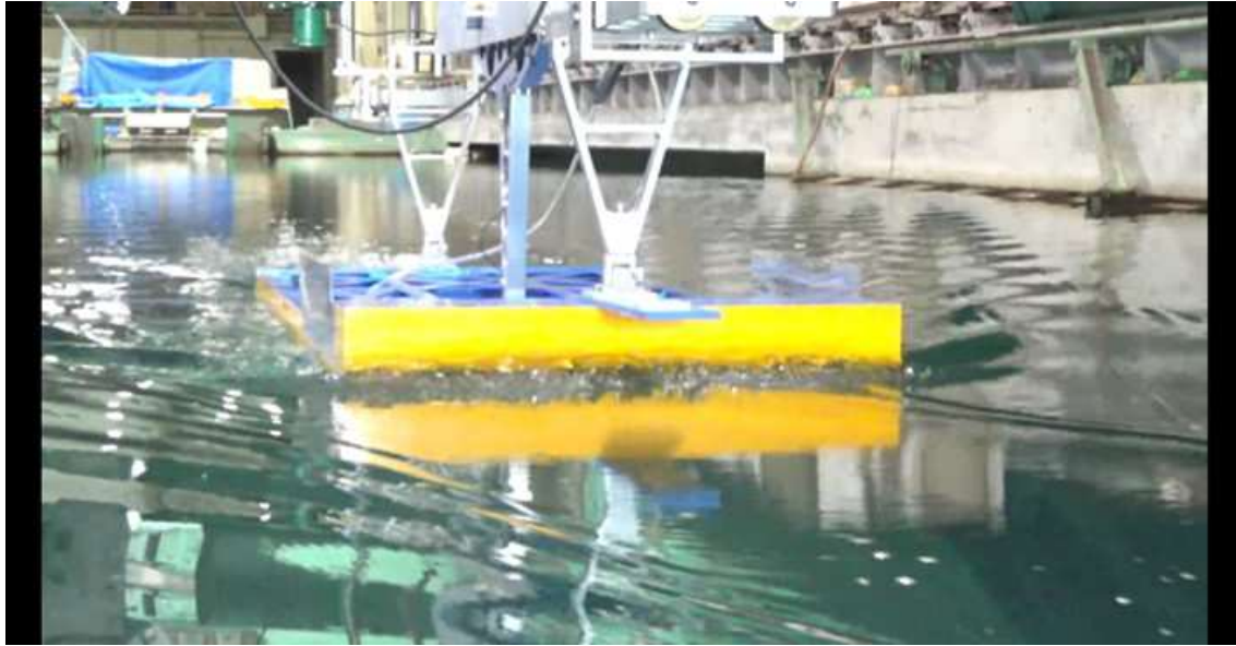
CASE-1、 d=3\text{m} 、 \text{trim}=1 V_m=0.924\text{m/s} 、 F_n=0.223 、 V_s=11.0\text{kn}
