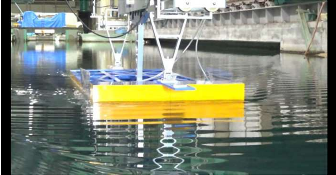
CASE-3、 d=3\text{m} 、 \text{trim}=0 V_m=0.492\text{m/s} 、 Fn=0.119 、 V_s=6.0\text{kn}
