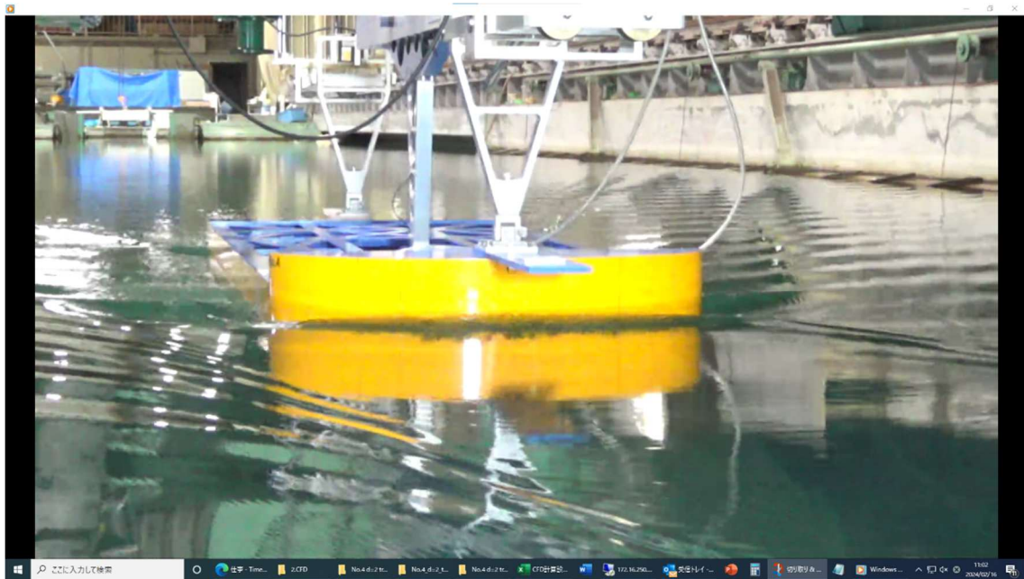
CASE-4、 d=2\text{m} 、 \text{trim}=0 V_m=0.820\text{m/s} 、 F_n=0.198 、 V_s=10.0\text{kn}
