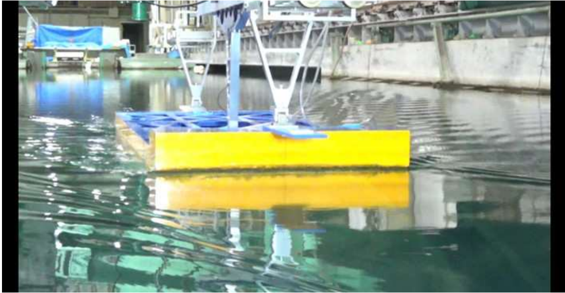
CASE-1、 d=2\text{m} 、 \text{trim}=0 V_m=0.756\text{m/s} 、 F_n=0.182 、 V_s=9.0\text{kn}
