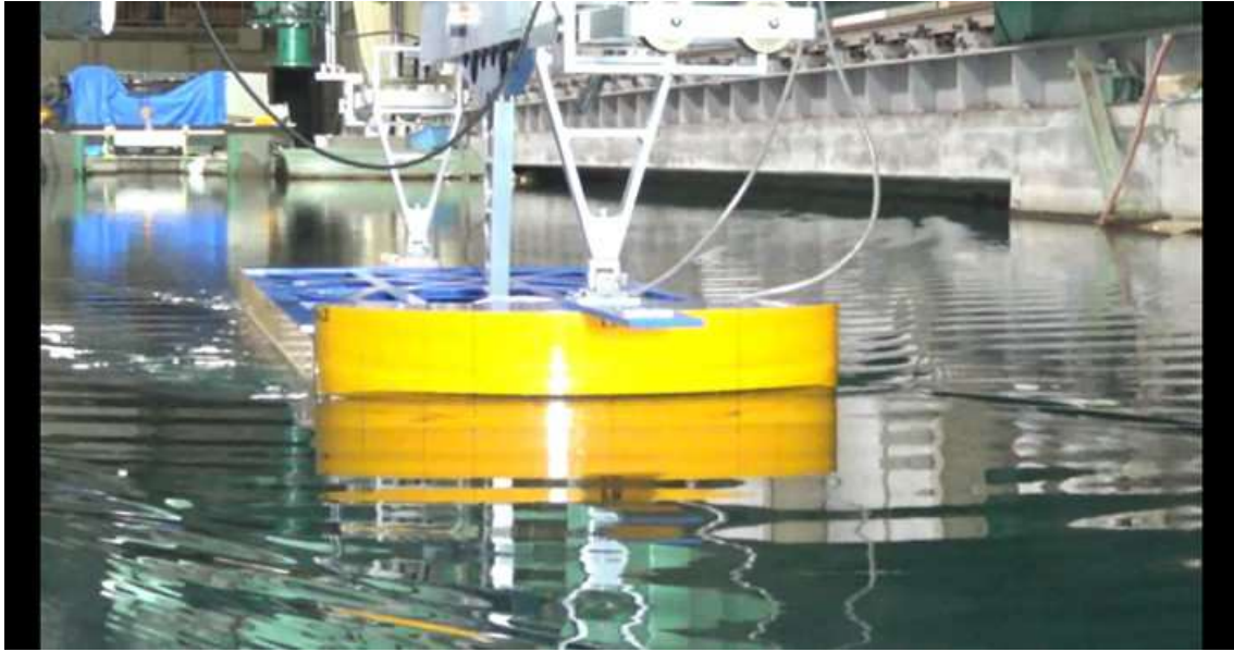
CASE-2、 d=2\text{m} 、 \text{trim}=0 V_m=0.588\text{m/s} 、 F_n=0.142 、 V_s=7.0\text{kn}
