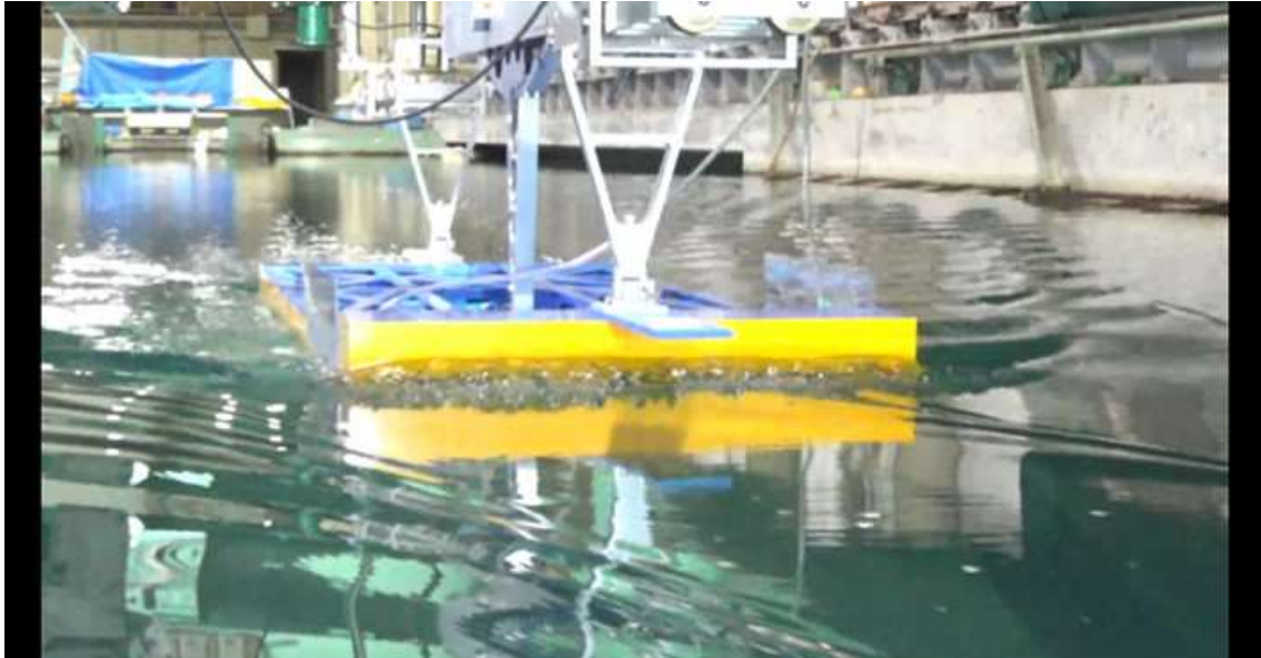
CASE-1、 d=3\text{m} 、 \text{trim}=0 V_m=0.924\text{m/s} 、 F_n=0.223 、 V_s=11.0\text{kn}
