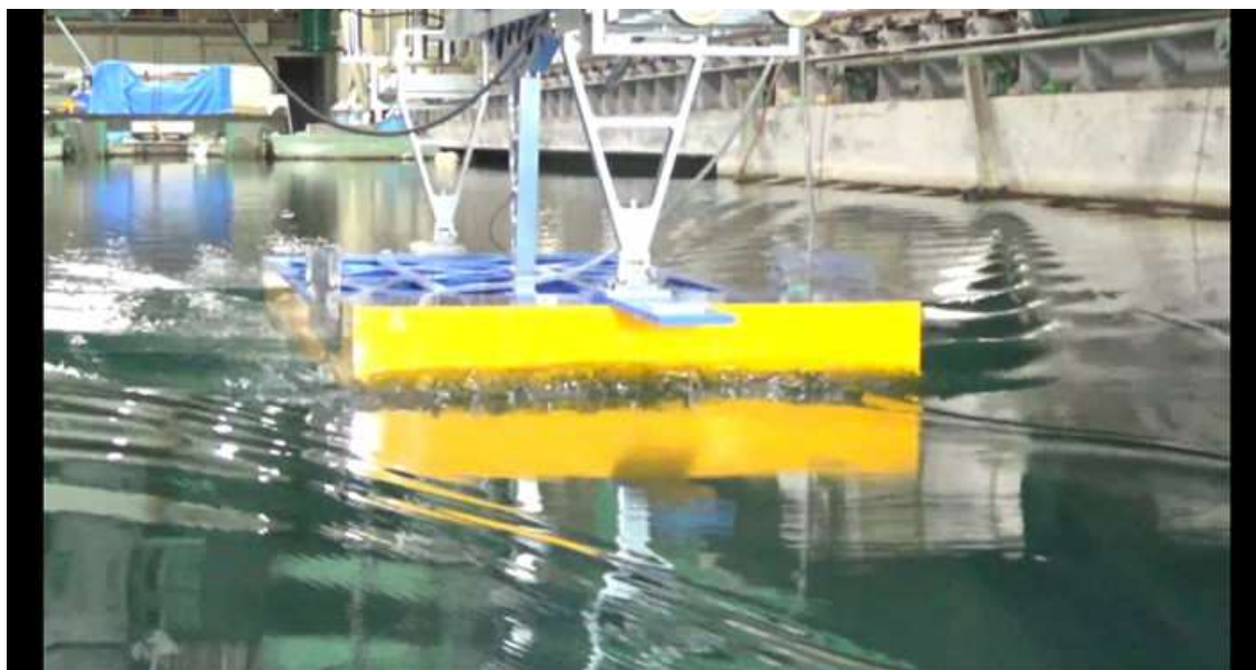
CASE-3、 d=2\text{m} 、 \text{trim}=0 V_m=0.902\text{m/s} 、 F_n=0.218 、 V_s=11.0\text{kn}
