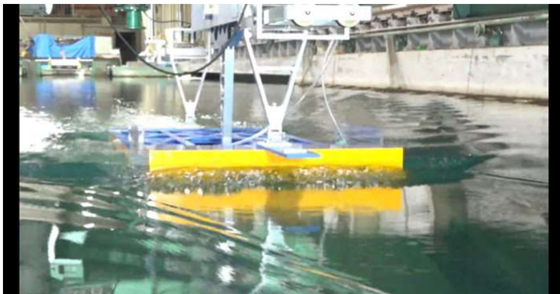
CASE-3、 d=3\text{m} 、 \text{trim}=1 V_m=0.984\text{m/s} 、 Fn=0.237 、 V_s=12.0\text{kn}
