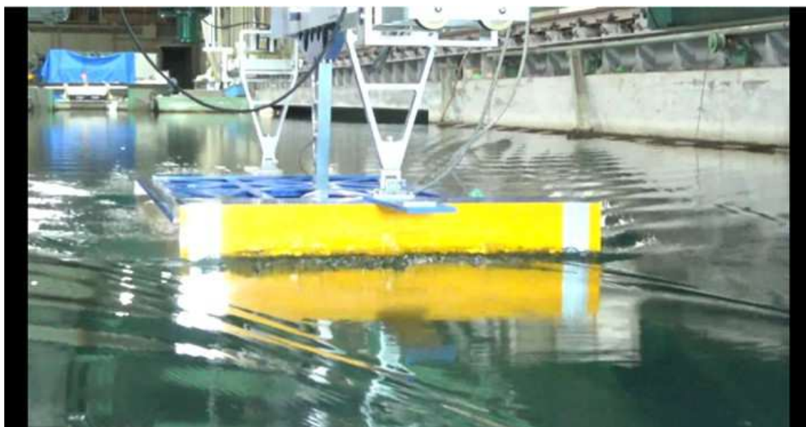
CASE-6、 d=2\text{m} 、 \text{trim}=0 V_m=0.924\text{m/s} 、 F_n=0.223 、 V_s=11.0\text{kn}
