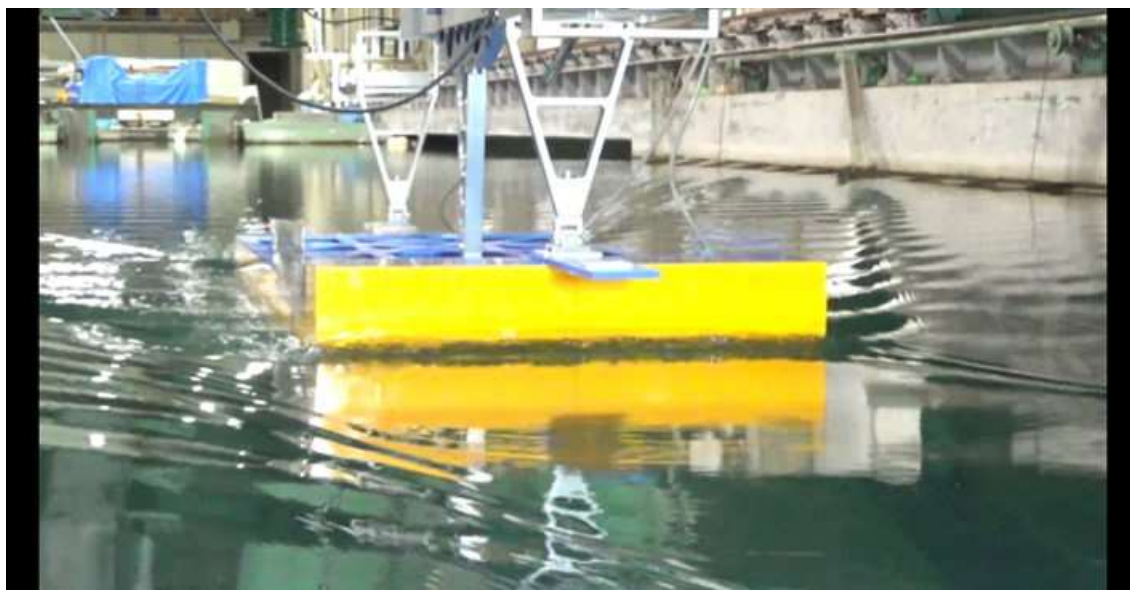
CASE-3、 d=2\text{m} 、 \text{trim}=1 V_m=0.820\text{m/s} 、 F_n=0.198 、 V_s=10.0\text{kn}
