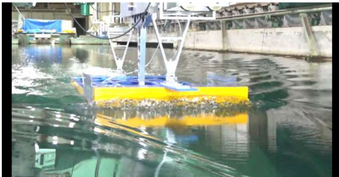
CASE-1、 d=3m 、 \text{trim}=1 V_m=1.092m/s 、 F_n=0.263 、 V_s=13.0kn
