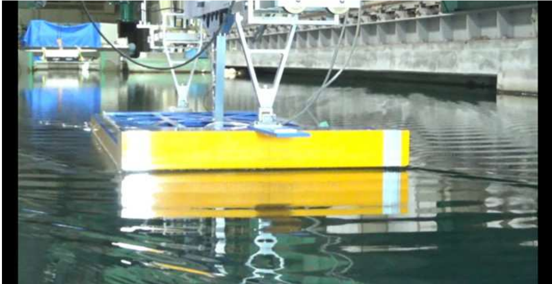
CASE-6、 d=2\text{m} 、 \text{trim}=0 V_m=0.588\text{m/s} 、 F_n=0.142 、 V_s=7.0\text{kn}
