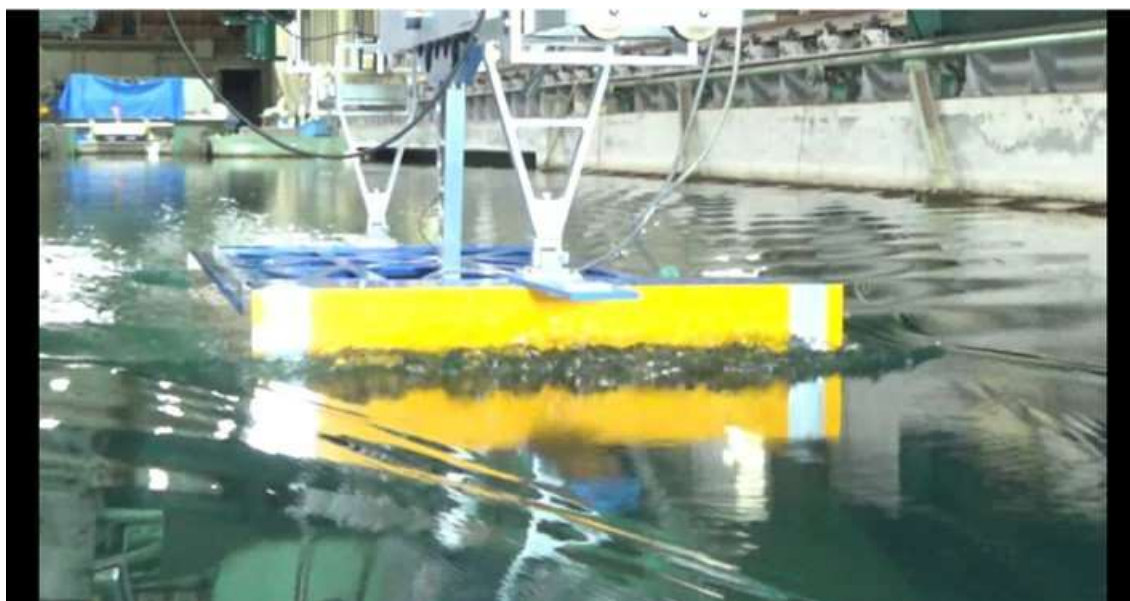
CASE-6、 d=2m 、 \text{trim}=0 V_m=1.092m/s 、 F_n=0.263 、 V_s=13.0kn
