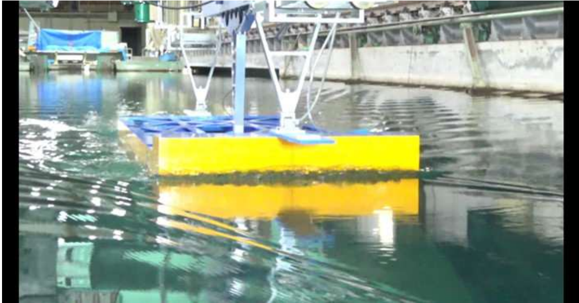
CASE-1、 d=2\text{m} 、 \text{trim}=0 V_m=0.924\text{m/s} 、 Fn=0.223 、 V_s=11.0\text{kn}
