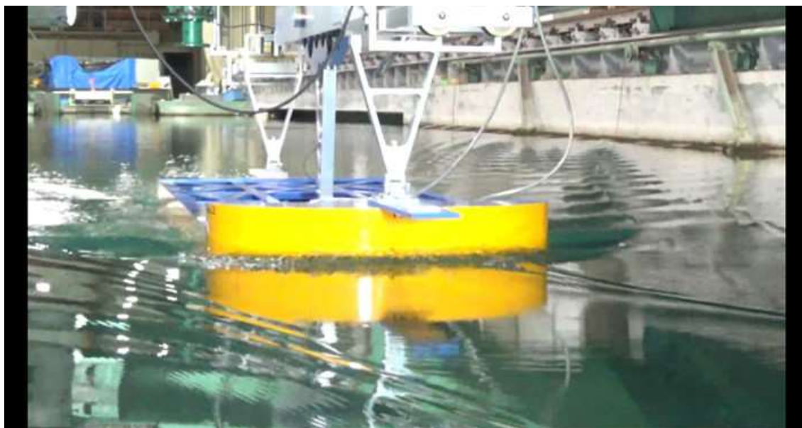
CASE-2、 d=2\text{m} 、 \text{trim}=0 V_m=0.924\text{m/s} 、 F_n=0.223 、 V_s=11.0\text{kn}
