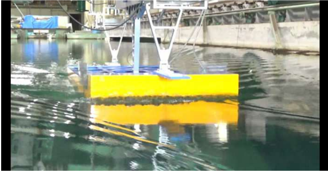
CASE-3、 d=2\text{m} 、 \text{trim}=1 V_m=0.902\text{m/s} 、 F_n=0.218 、 V_s=11.0\text{kn}
