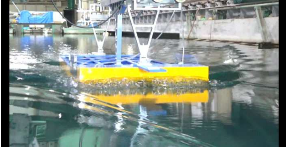
CASE-3、 d=2\text{m} 、 \text{trim}=0 V_m=1.066\text{m/s} 、 F_n=0.257 、 V_s=13.0\text{kn}
