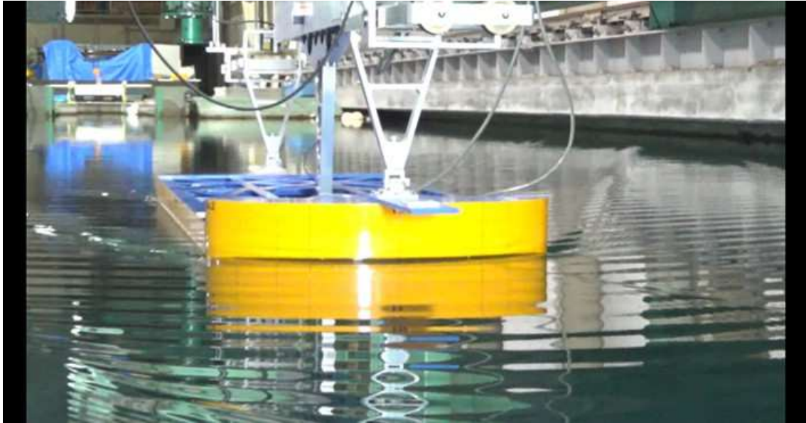
CASE-2、 d=2\text{m} 、 \text{trim}=0 V_m=0.504\text{m/s} 、 F_n=0.122 、 V_s=6.0\text{kn}
