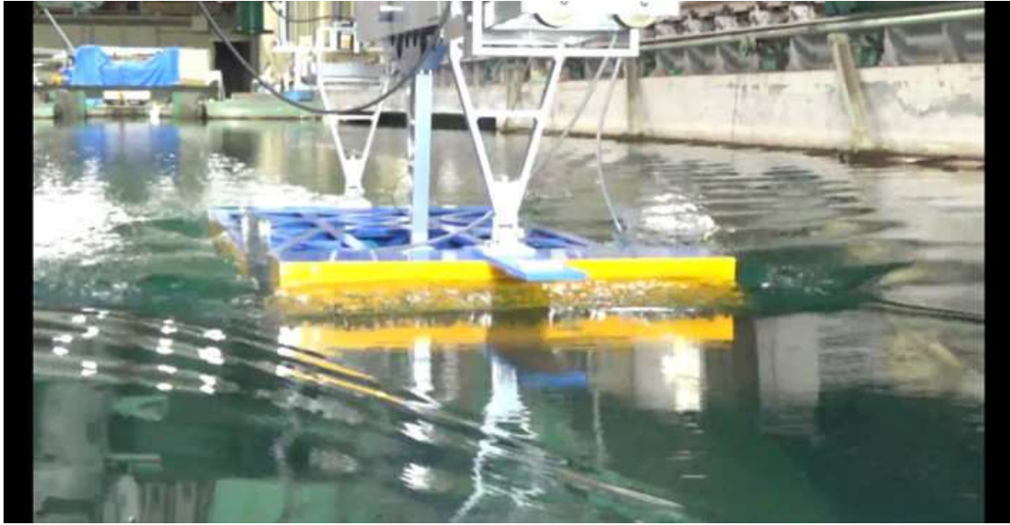
CASE-3、 d=3\text{m} 、 \text{trim}=0 V_m=0.984\text{m/s} 、 F_n=0.237 、 V_s=12.0\text{kn}
