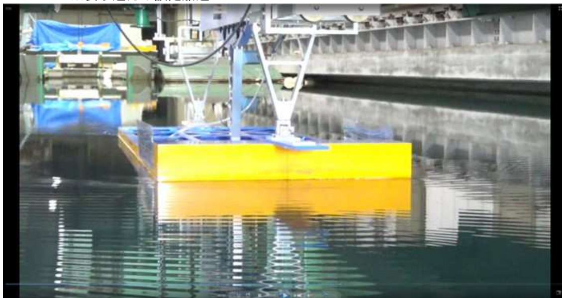
CASE-1、 d=3\text{m} 、 \text{trim}=1 V_m=0.336\text{m/s} 、 Fn=0.081 、 V_s=4.0\text{kn}
