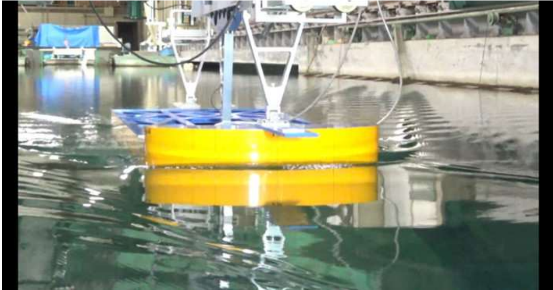
CASE-4、 d=2\text{m} 、 \text{trim}=0 V_m=0.738\text{m/s} 、 F_n=0.178 、 V_s=9.0\text{kn}
