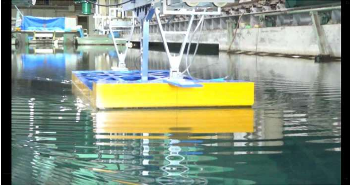
CASE-1、 d=2\text{m} 、 \text{trim}=0 V_m=0.504\text{m/s} 、 F_n=0.122 、 V_s=6.0\text{kn}
