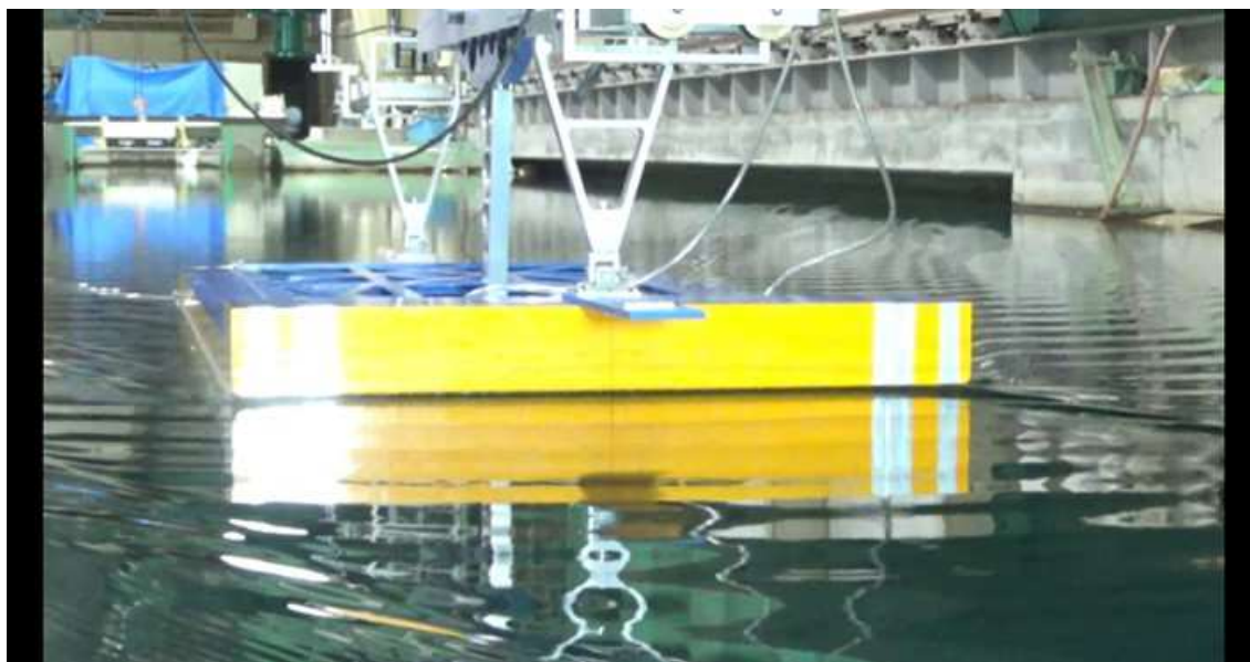
CASE-7、 d=2\text{m} 、 \text{trim}=0 V_m=0.588\text{m/s} 、 F_n=0.142 、 V_s=7.0\text{kn}
