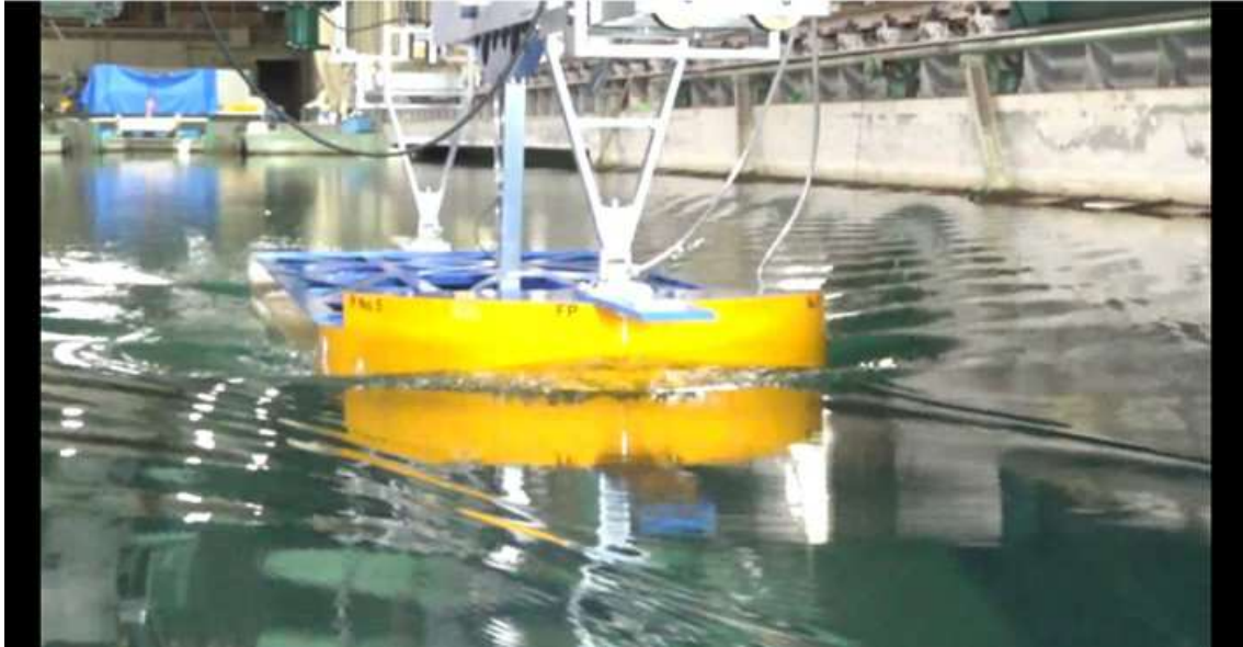
CASE-5、 d=2\text{m} 、 \text{trim}=0 V_m=0.886\text{m/s} 、 F_n=0.214 、 V_s=11.0\text{kn}
