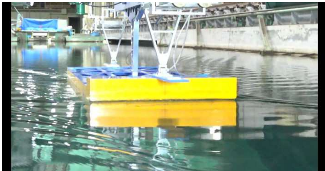
CASE-1、 d=2\text{m} 、 \text{trim}=0 V_m=0.672\text{m/s} 、 F_n=0.162 、 V_s=8.0\text{kn}
