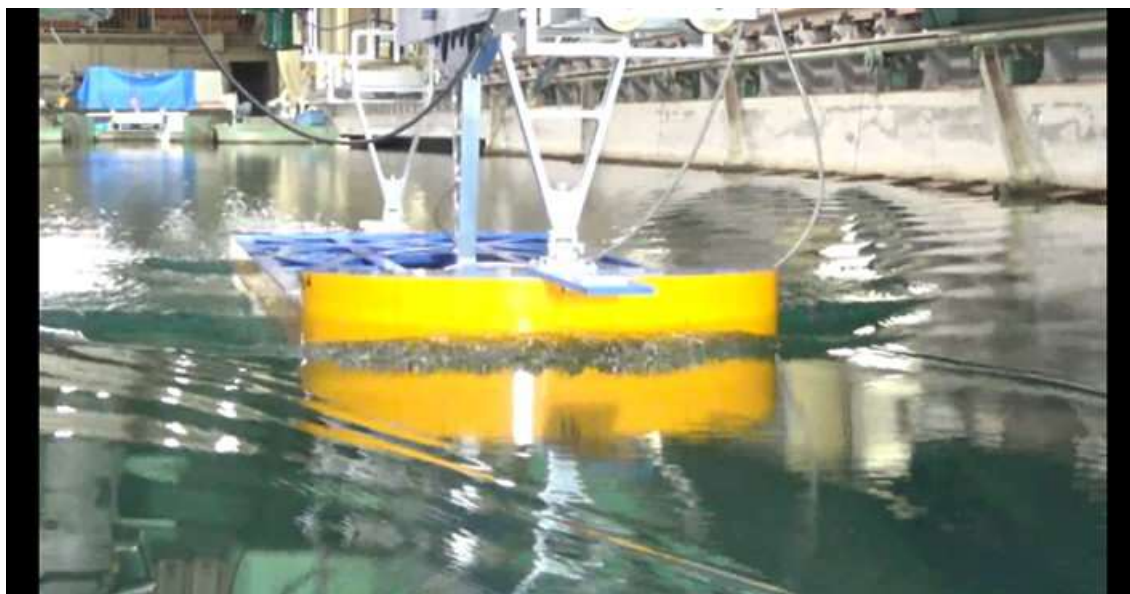
CASE-4、 d=2\text{m} 、 \text{trim}=0 V_m=0.984\text{m/s} 、 F_n=0.237 、 V_s=12.0\text{kn}
