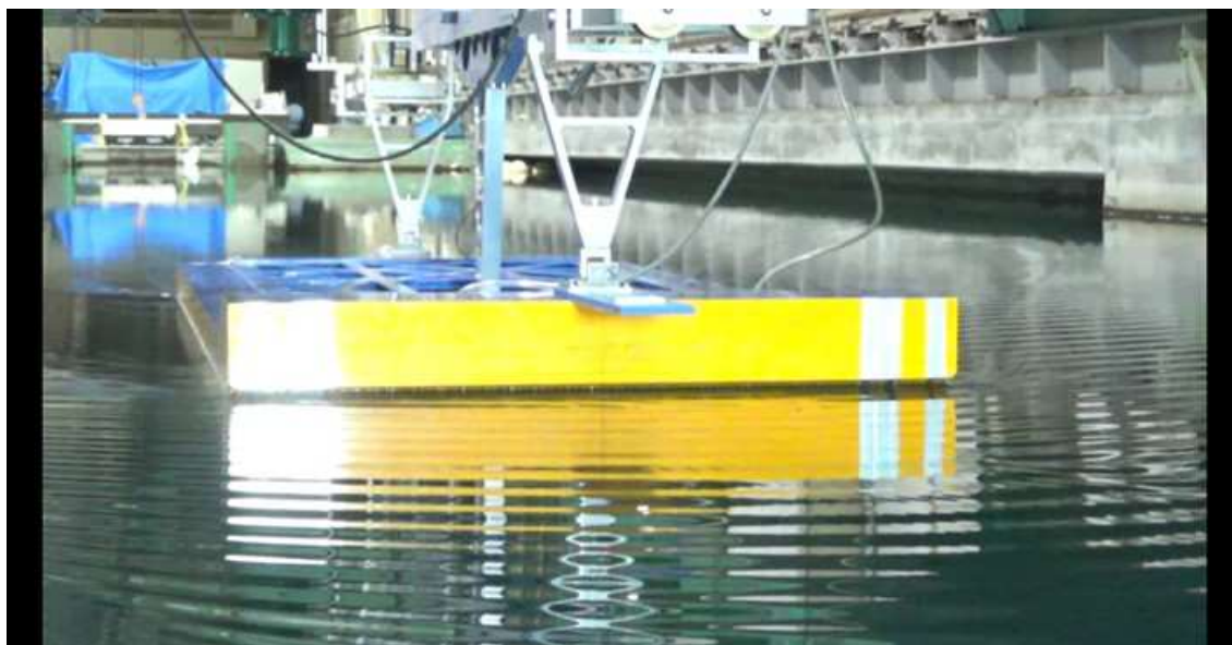
CASE-7、 d=2\text{m} 、 \text{trim}=0 、 V_m=0.420\text{m/s} 、 F_n=0.101 、 V_s=5.0\text{kn}
