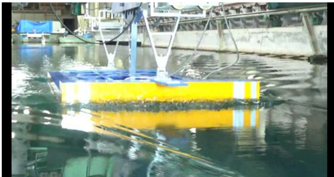
CASE-7、 d=2\text{m} 、 \text{trim}=0 V_m=1.092\text{m/s} 、 F_n=0.263 、 V_s=13.0\text{kn}
