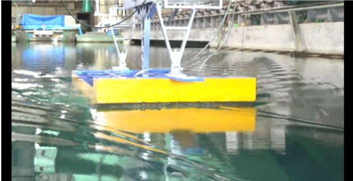
CASE-1、 d=2\text{m} 、 \text{trim}=1 V_m=0.924\text{m/s} 、 Fn=0.223 、 V_s=11.0\text{kn}
