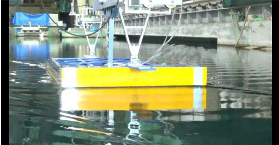
CASE-6、 d=2\text{m} 、 \text{trim}=0 V_m=0.672\text{m/s} 、 F_n=0.162 、 V_s=8.0\text{kn}
