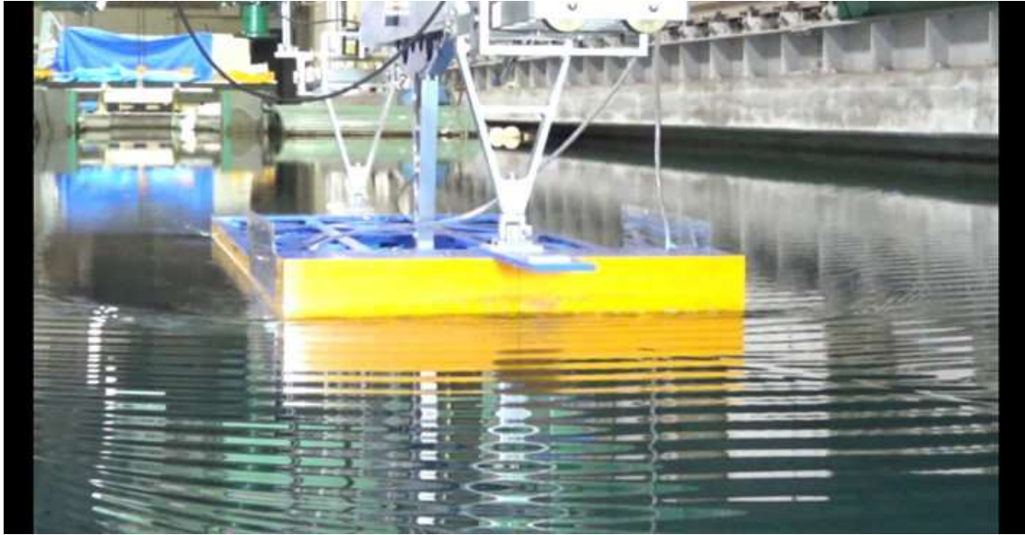
CASE-1、 d=3\text{m} 、 \text{trim}=0 V_m=0.420\text{m/s} 、 F_n=0.101 、 V_s=5.0\text{kn}
