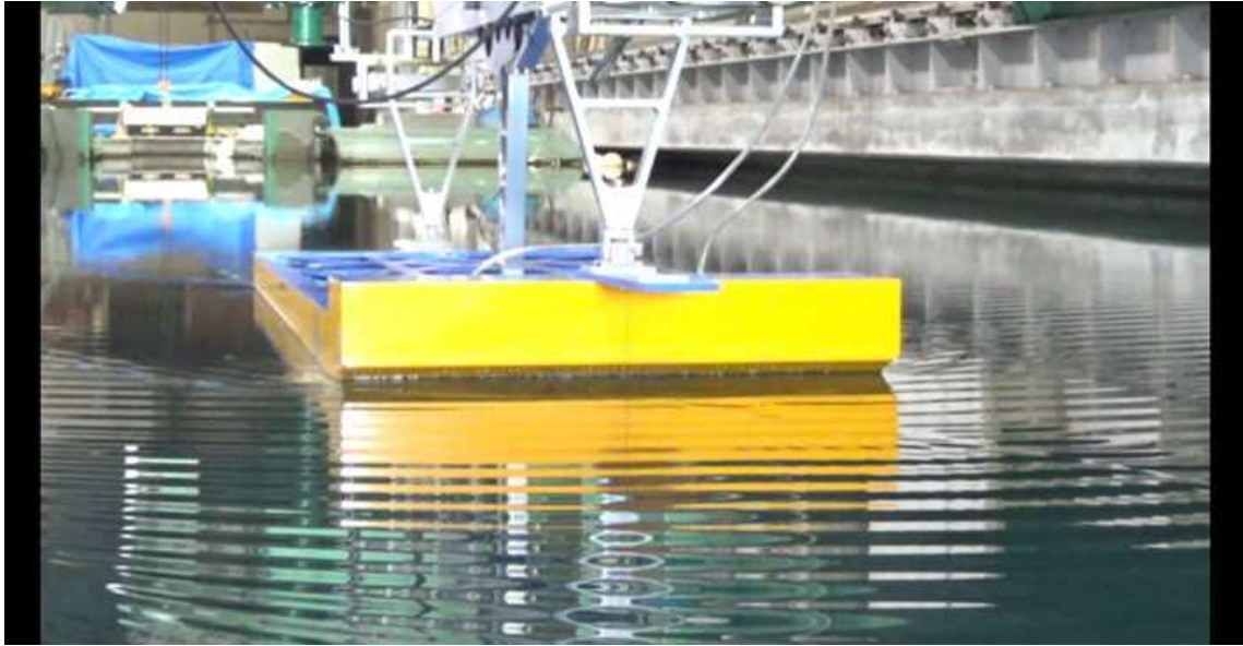
CASE-1、 d=2\text{m} 、 \text{trim}=1 V_m=0.420\text{m/s} 、 F_n=0.101 、 V_s=5.0\text{kn}
