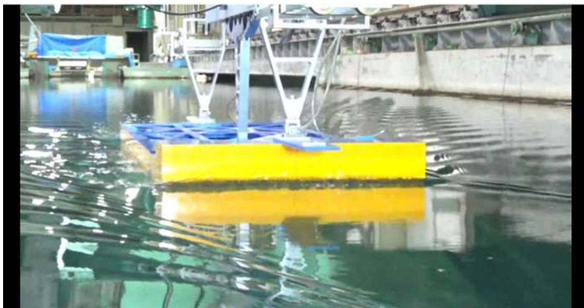
CASE-1、 d=2\text{m} 、 \text{trim}=0 V_m=0.840\text{m/s} 、 Fr=0.203 、 V_s=10.0\text{kn}
