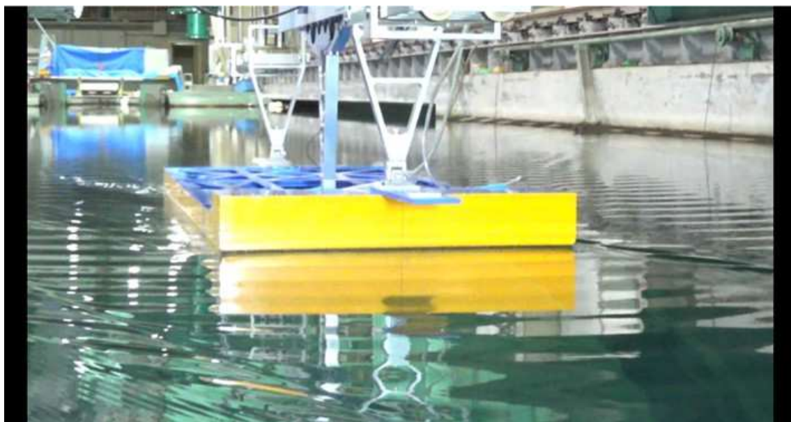
CASE-1、 d=2m 、 \text{trim}=0 V_m=0.588m/s 、 Fn=0.142 、 V_s=7.0kn
