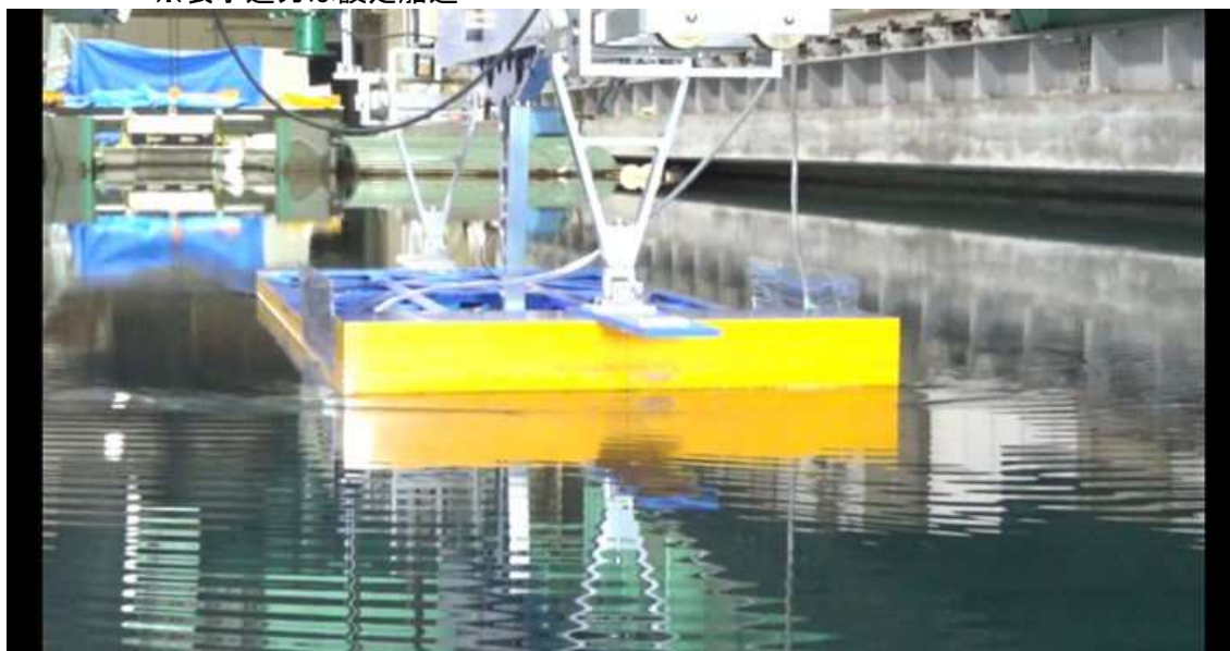
CASE-1、 d=3\text{m} 、 \text{trim}=0 V_m=0.336\text{m/s} 、 F_n=0.081 、 V_s=4.0\text{kn}
