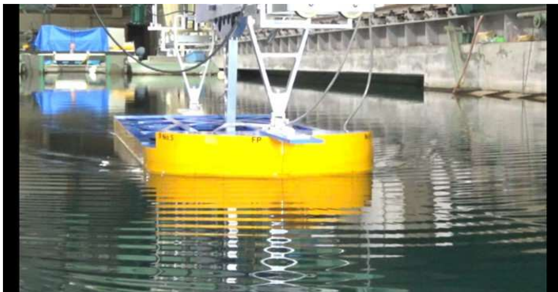
CASE-5、 d=2\text{m} 、 \text{trim}=0 V_m=0.403\text{m/s} 、 F_n=0.097 、 V_s=5.0\text{kn}
