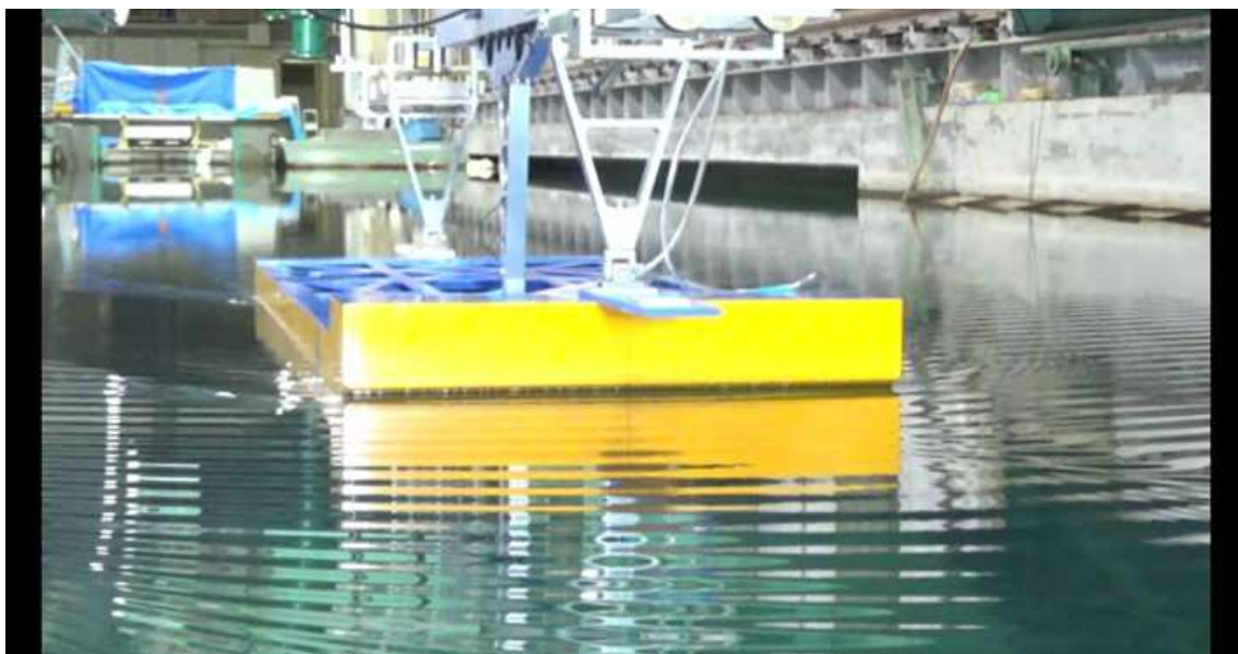
CASE-1、 d=2\text{m} 、 \text{trim}=0 、 V_m=0.420\text{m/s} 、 F_n=0.101 、 V_s=5.0\text{kn}
