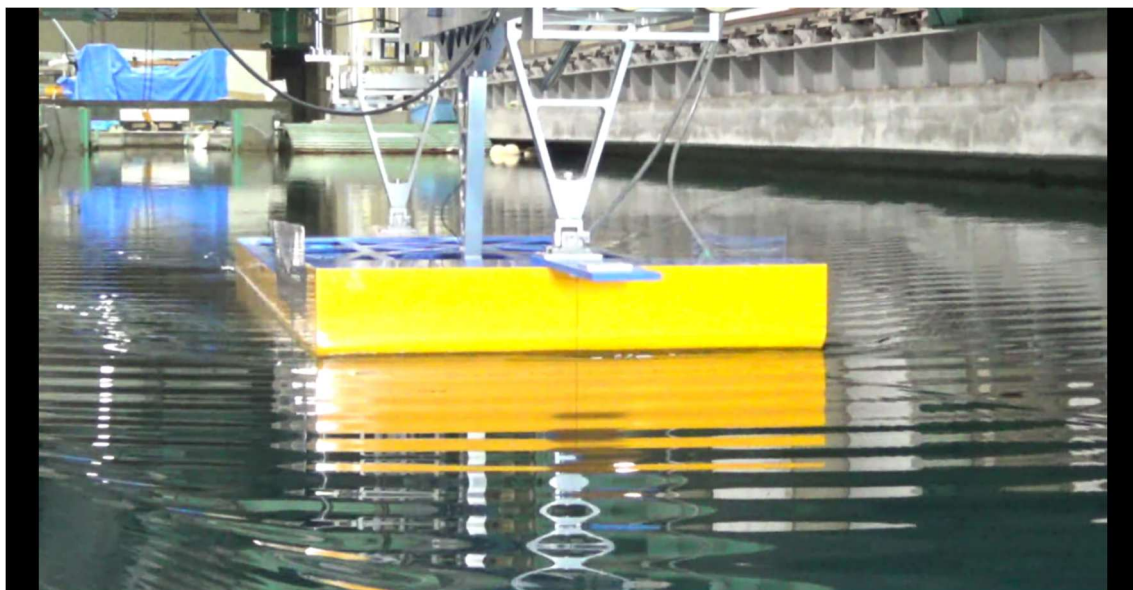
CASE-3、 d=2\text{m} 、 \text{trim}=1 V_m=0.492\text{m/s} 、 F_n=0.119 、 V_s=6.0\text{kn}
