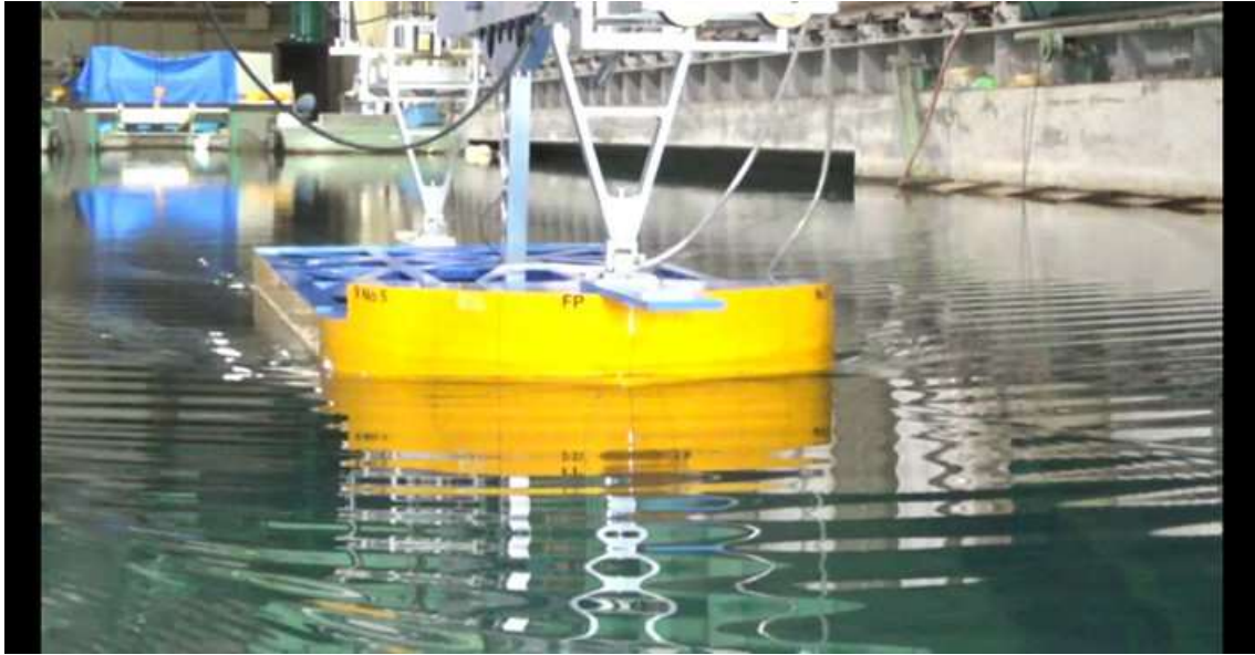
CASE-5、 d=2\text{m} 、 \text{trim}=0 V_m=0.483\text{m/s} 、 F_n=0.117 、 V_s=6.0\text{kn}
