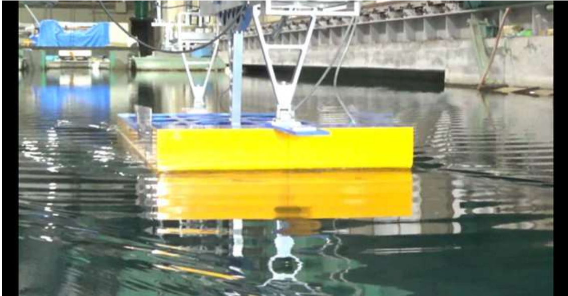
CASE-3、 d=2\text{m} 、 \text{trim}=1 V_m=0.574\text{m/s} 、 F_n=0.139 、 V_s=7.0\text{kn}
