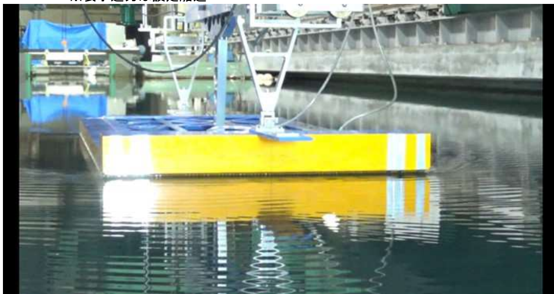
CASE-7、 d=2\text{m} 、 \text{trim}=0 V_m=0.336\text{m/s} 、 F_n=0.081 、 V_s=4.0\text{kn}
