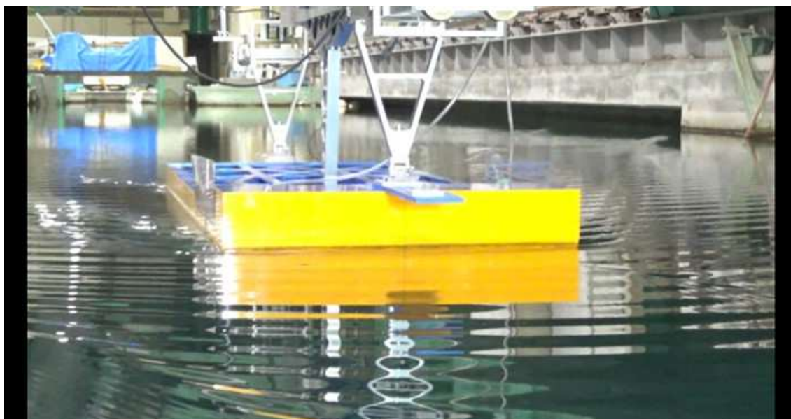
CASE-3、 d=2\text{m} 、 \text{trim}=0 V_m=0.492\text{m/s} 、 Fn=0.119 、 V_s=6.0\text{kn}
