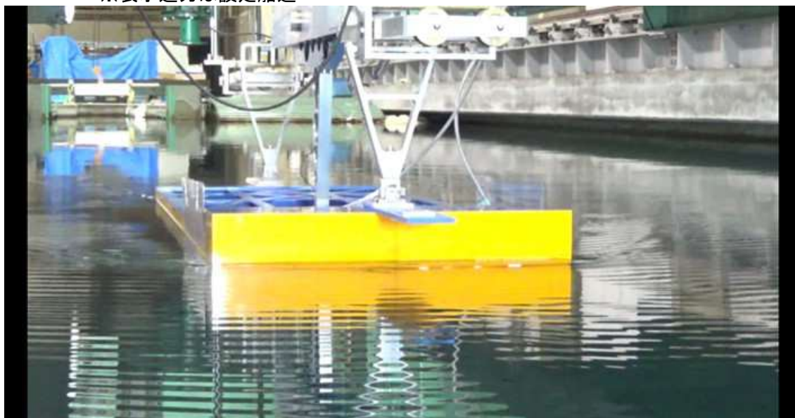
CASE-3、 d=3\text{m} 、 \text{trim}=1 V_m=0.328\text{m/s} 、 Fn=0.079 、 V_s=4.0\text{kn}
