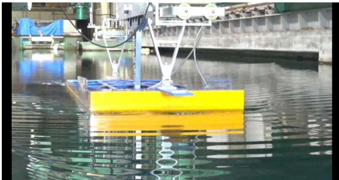
CASE-3、 d=3\text{m} 、 \text{trim}=1 V_m=0.492\text{m/s} 、 F_n=0.119 、 V_s=6.0\text{kn}
