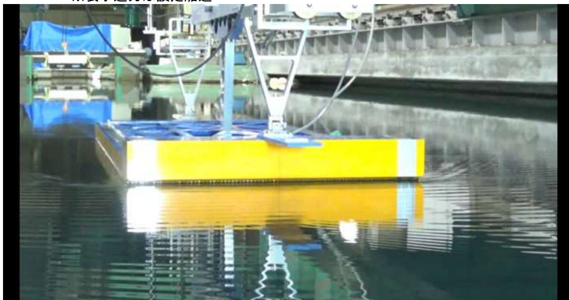
CASE-6、 d=2\text{m} 、 \text{trim}=0 V_m=0.336\text{m/s} 、 F_n=0.081 、 V_s=4.0\text{kn}
