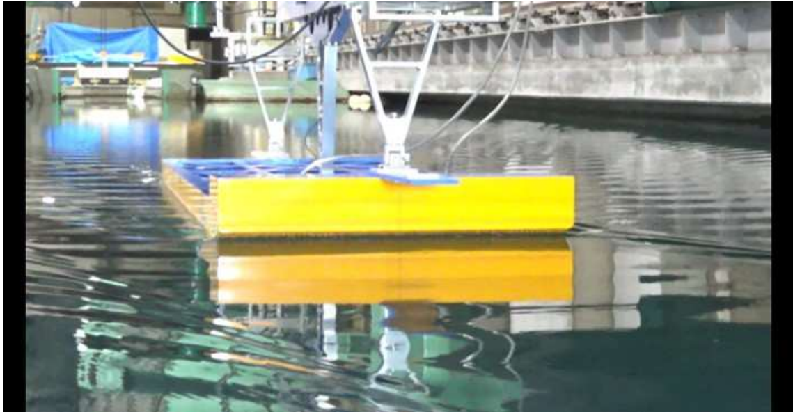
CASE-1、 d=2\text{m} 、 \text{trim}=1 V_m=0.672\text{m/s} 、 F_n=0.162 、 V_s=8.0\text{kn}
