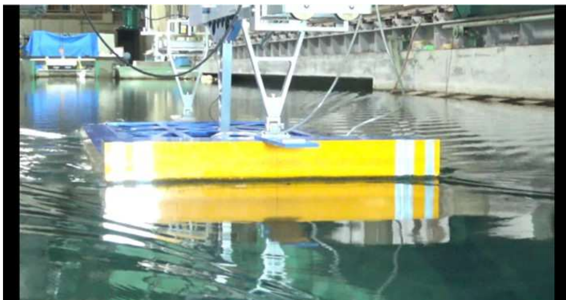
CASE-7、 d=2\text{m} 、 \text{trim}=0 V_m=0.756\text{m/s} 、 F_n=0.182 、 V_s=9.0\text{kn}
