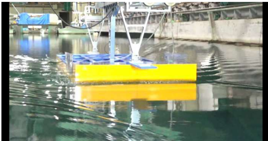
CASE-3、 d=2\text{m} 、 \text{trim}=0 V_m=0.738\text{m/s} 、 F_n=0.178 、 V_s=9.0\text{kn}
