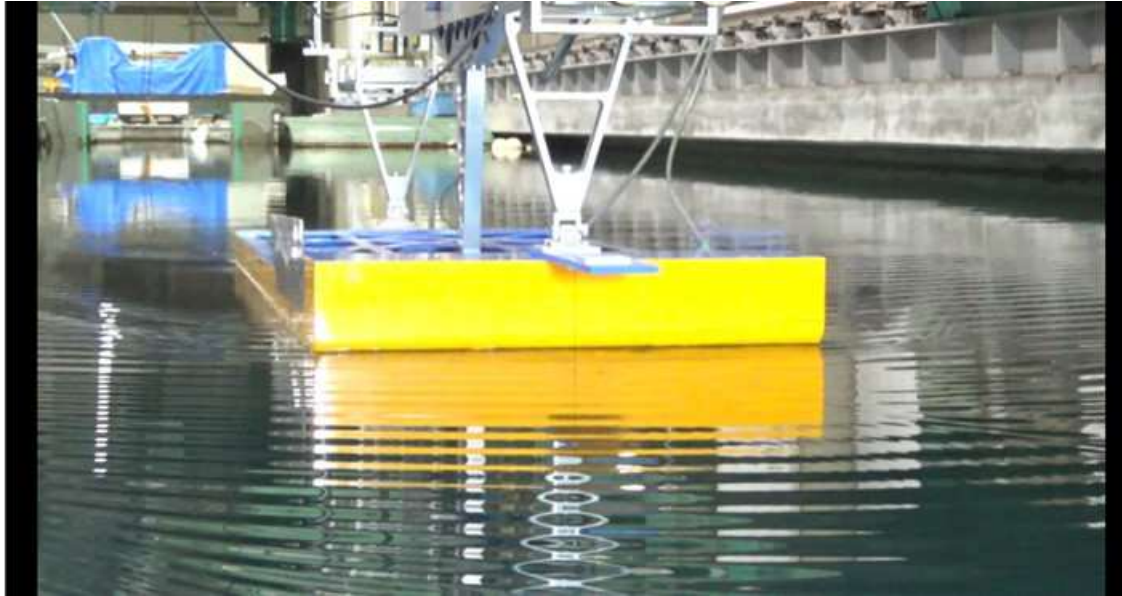
CASE-3、 d=2\text{m} 、 \text{trim}=1 V_m=0.410\text{m/s} 、 Fn=0.099 、 V_s=5.0\text{kn}
