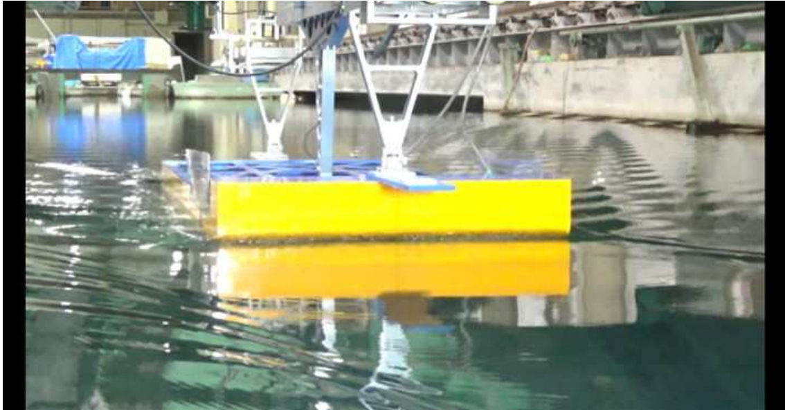
CASE-3、 d=2\text{m} 、 \text{trim}=1 V_m=0.738\text{m/s} 、 Fn=0.178 、 V_s=9.0\text{kn}
