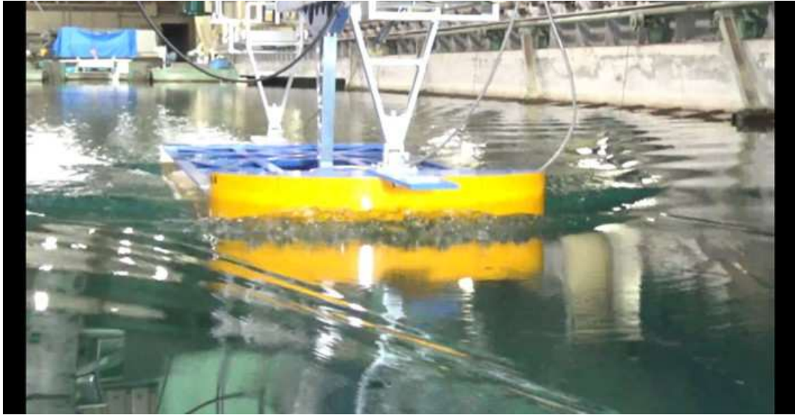
CASE-4、 d=2\text{m} 、 \text{trim}=0 V_m=1.066\text{m/s} 、 F_n=0.257 、 V_s=13.0\text{kn}
