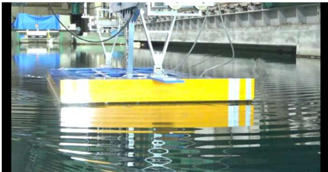
CASE-7、 d=2\text{m} 、 \text{trim}=0 V_m=0.504\text{m/s} 、 F_n=0.122 、 V_s=6.0\text{kn}
