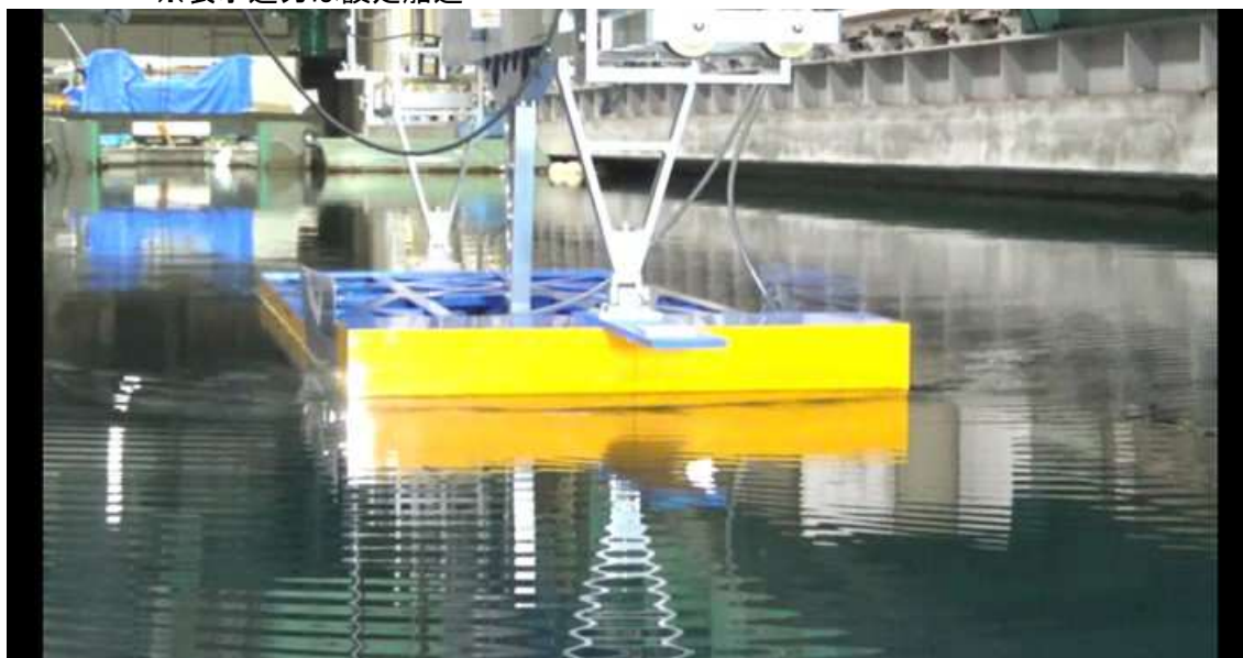
CASE-3、 d=3\text{m} 、 \text{trim}=0 V_m=0.328\text{m/s} 、 F_n=0.079 、 V_s=4.0\text{kn}
