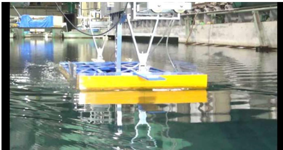
CASE-3、 d=3\text{m} 、 \text{trim}=0 V_m=0.656\text{m/s} 、 Fn=0.158 、 V_s=8.0\text{kn}
