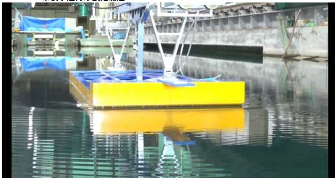
CASE-1、 d=2\text{m} 、 \text{trim}=0 V_m=0.336\text{m/s} 、 F_n=0.081 、 V_s=4.0\text{kn}
