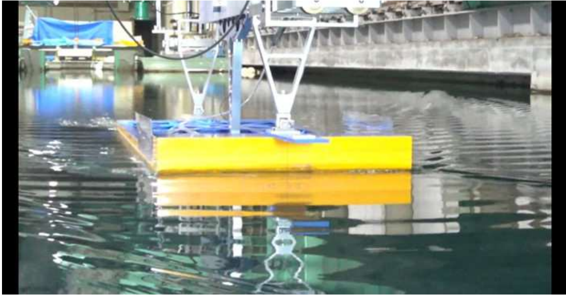
CASE-1、 d=3\text{m} 、 \text{trim}=1 V_m=0.588\text{m/s} 、 F_n=0.142 、 V_s=7.0\text{kn}
