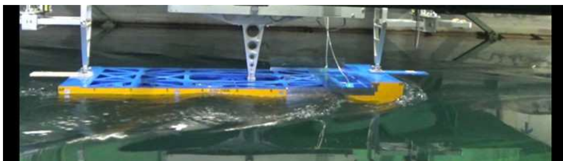
CASE-3、 d=3\text{m} 、 \text{trim}=1 V_m=1.066\text{m/s} 、 F_n=0.257 、 V_s=13.0\text{kn}
