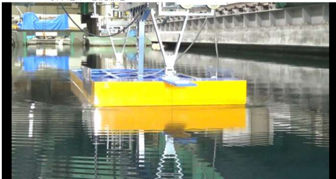
CASE-3、 d=2\text{m} 、 \text{trim}=0 V_m=0.328\text{m/s} 、 F_n=0.079 、 V_s=4.0\text{kn}
