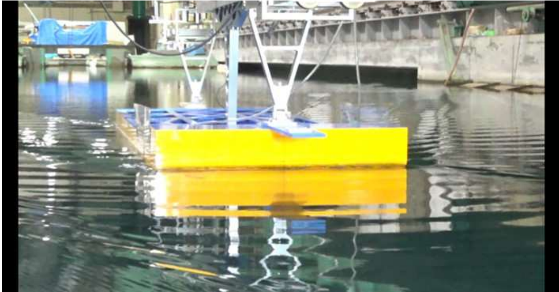
CASE-3、 d=2\text{m} 、 \text{trim}=0 V_m=0.574\text{m/s} 、 Fn=0.139 、 V_s=7.0\text{kn}
