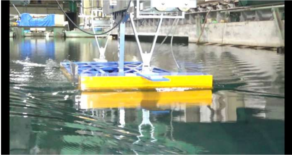
CASE-3、 d=3m 、 \text{trim}=0 V_m=0.738m/s 、 Fn=0.178 、 V_s=9.0kn
