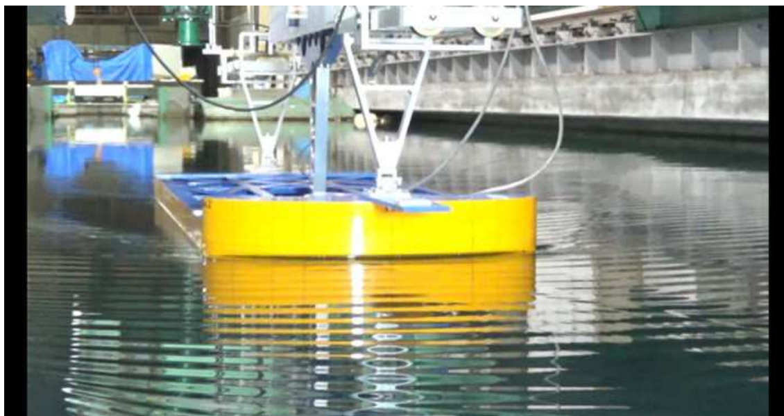
CASE-2、 d=2\text{m} 、 \text{trim}=0 V_m=0.420\text{m/s} 、 F_n=0.101 、 V_s=5.0\text{kn}
