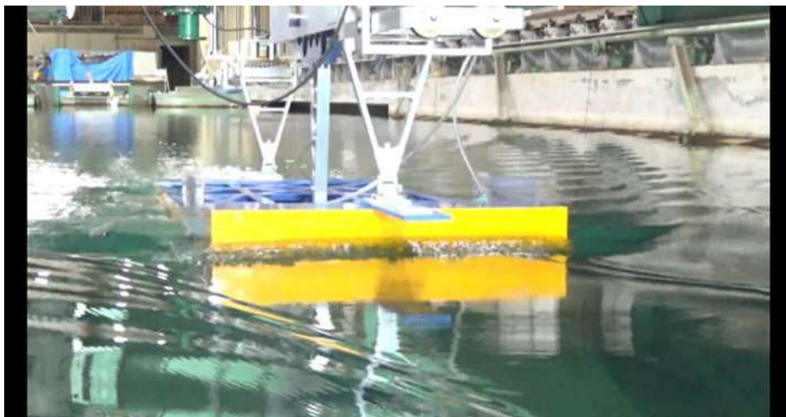
CASE-3、 d=3\text{m} 、 \text{trim}=1 V_m=0.902\text{m/s} 、 F_n=0.218 、 V_s=11.0\text{kn}
