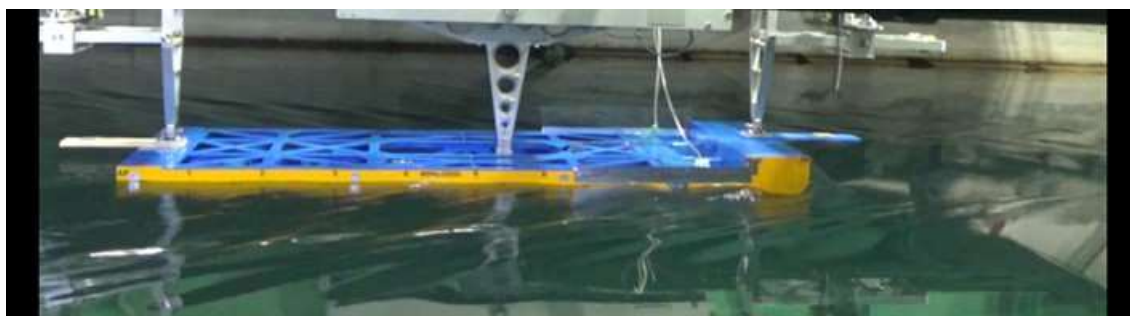
CASE-3、 d=3\text{m} 、 \text{trim}=1 V_m=0.738\text{m/s} 、 F_n=0.178 、 V_s=9.0\text{kn}
