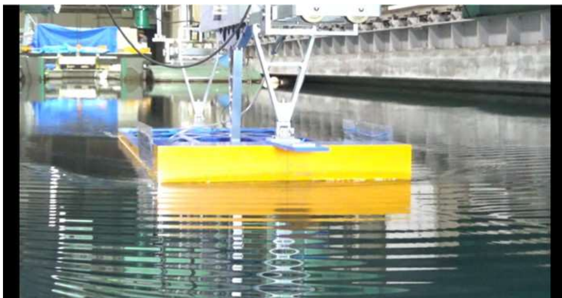
CASE-1、 d=3\text{m} 、 \text{trim}=1 V_m=0.420\text{m/s} 、 F_n=0.101 、 V_s=5.0\text{kn}
