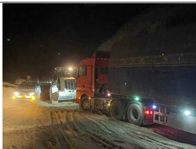
路面が柔らかい砂であるため、タイヤがスリップし 立ち往生しているトラック ショベルカーにけん引されている
