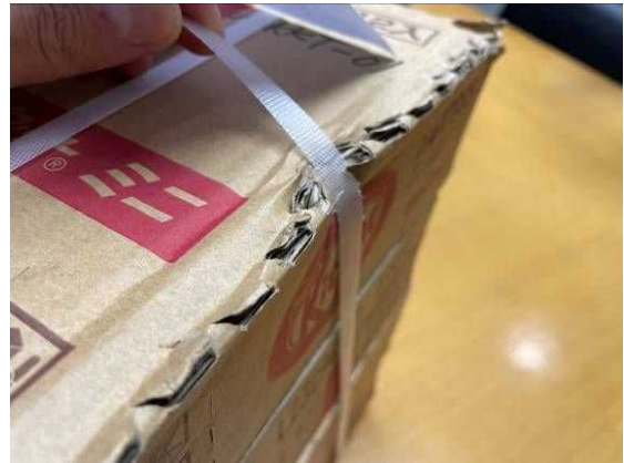
バンドによるカートンの凹み
