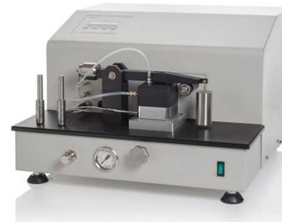
試験器(BOCLE) 試験方法：ASTM D5001
