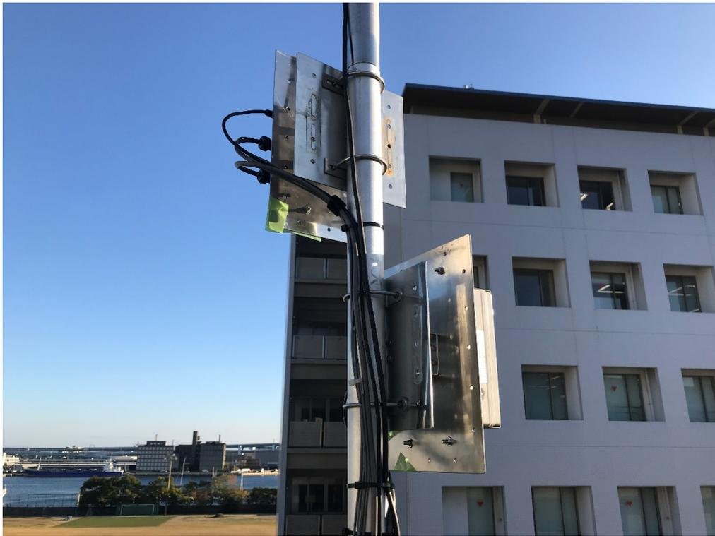
図7 屋上に設置したCWレーダー
