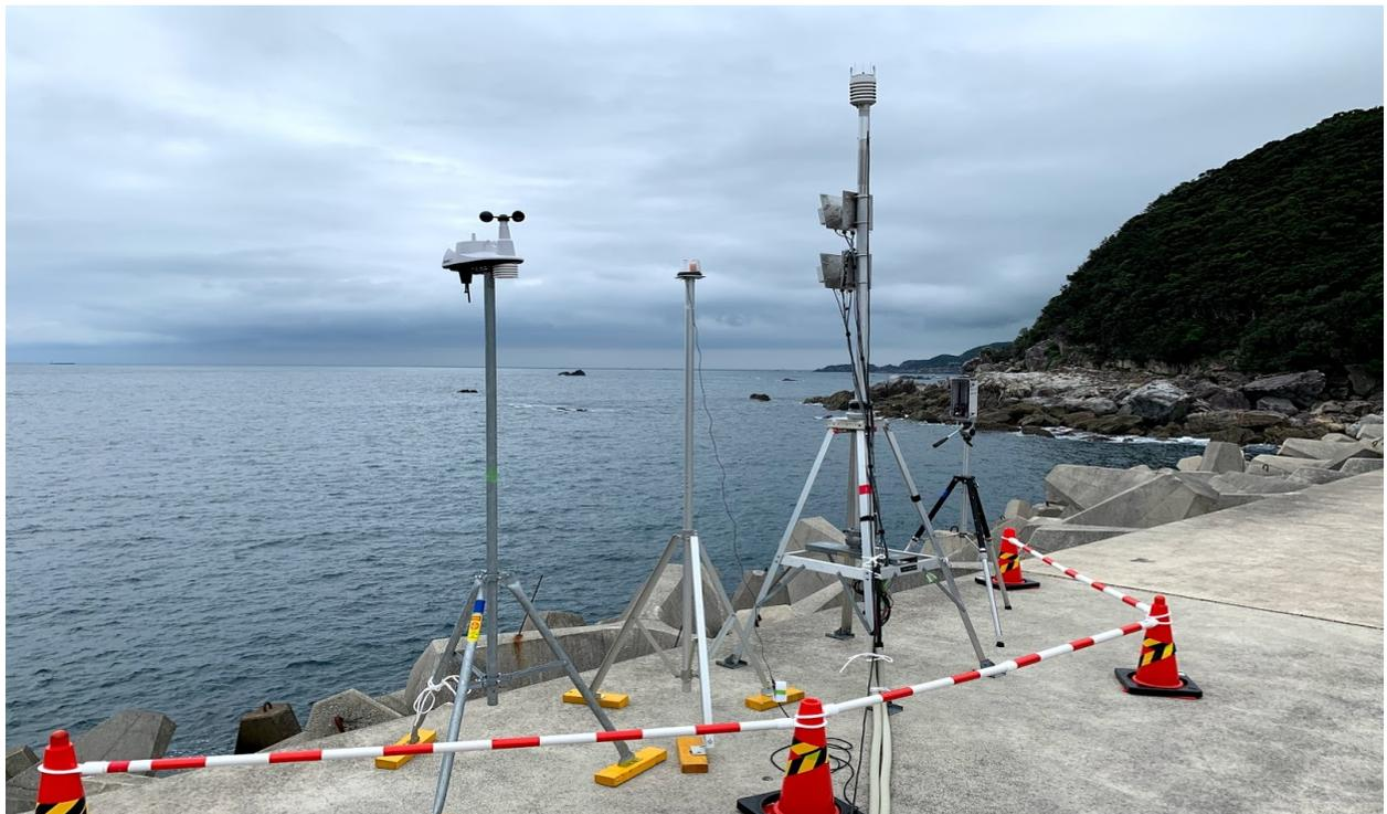
図 5 FM-CW レーダー実験における防波堤状の装置
