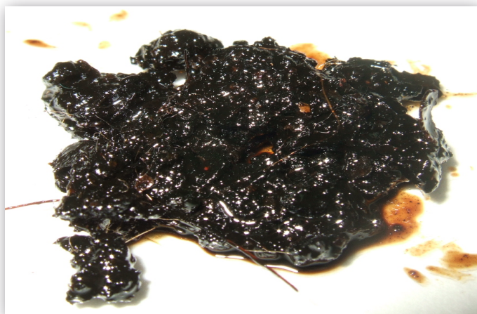
C重油中のスラッジ
