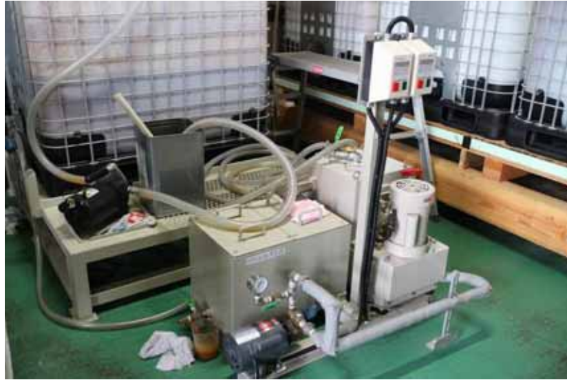
Fig. 3-8 (株) ダイキアクシス社製，D・Oil 200A 原料前処理部外観 (於 JOY さあくる，2013年12月10日撮影)
