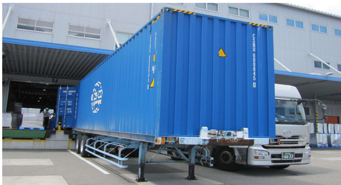
Fig4. 使用した 40 フィートのドライコンテナ及び2 軸トレーラー
